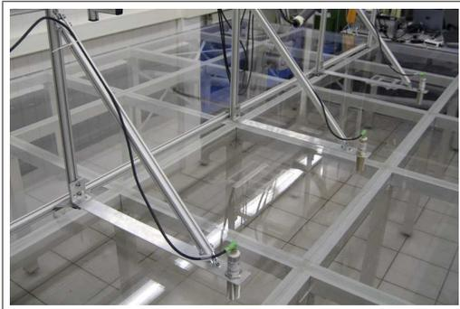
(b) Sensoren an Laufschienen
