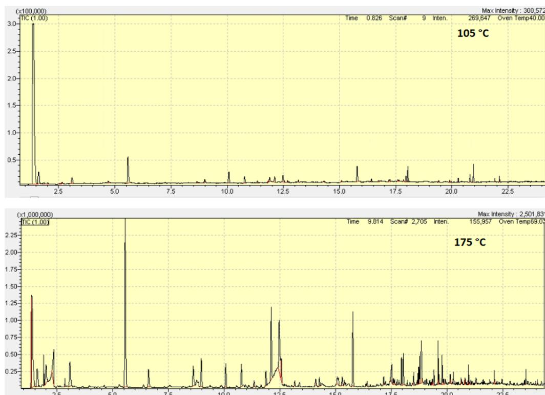
**Abbildung 35.** Vergleich der flüchtigen Bestandteile bei Temperaturen von 105 °C (0-300 k TIC) und 175 °C (0-2,25 m TIC)
