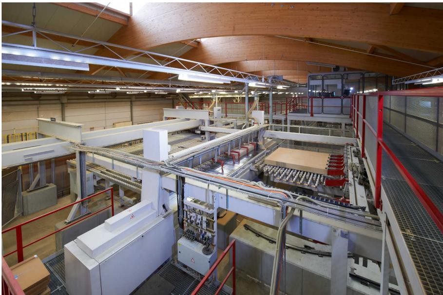
Abbildung 6.15: Vollautomatische Sägeanlage mit Peripherie
