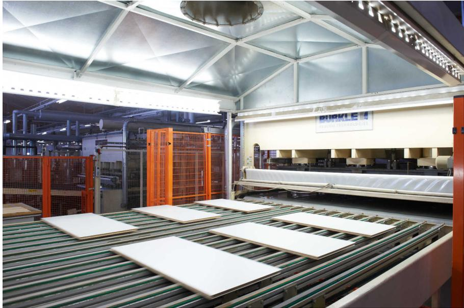
Abbildung 6.16: Vollautomatische Pressenanlage mit Auslaufband
