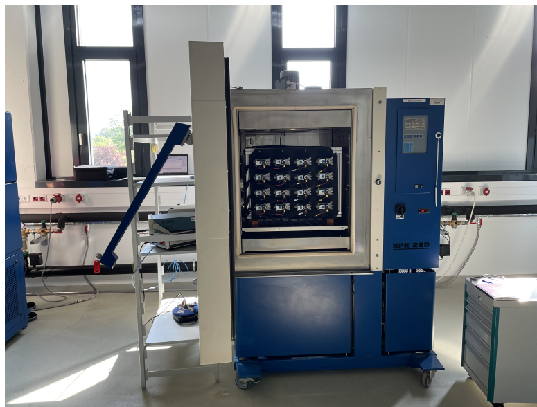
Abbildung 5.6: Bild des in die klimatisierte Einheit integrierten Dauerversuchsaufbaus.
