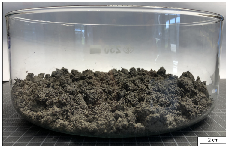
Abbildung 30: Schleifschlamm im Anlieferungszustand vor der Trocknung.
