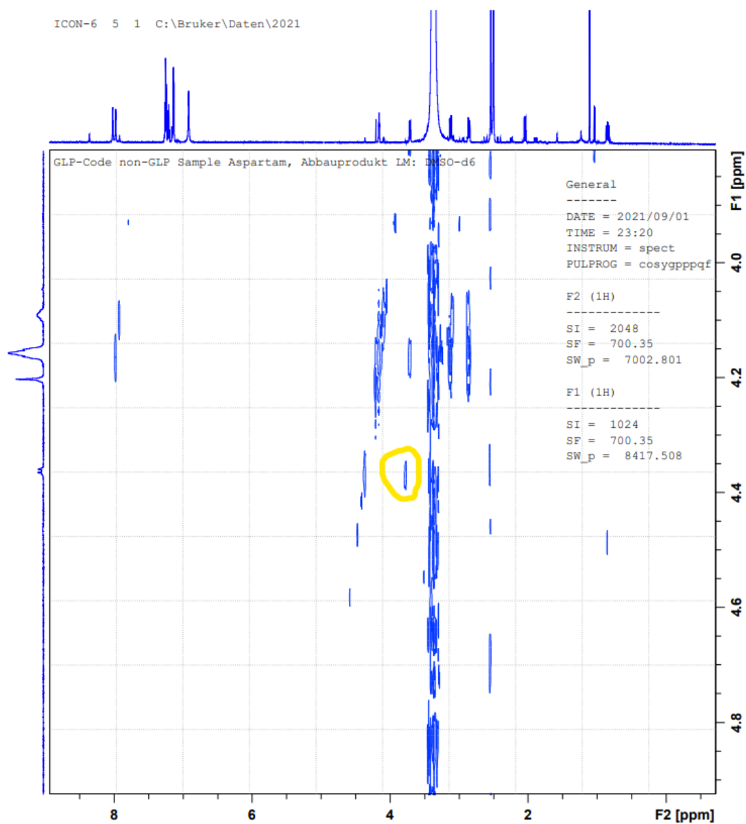
Abbildung 77: Zoom COSY-Spektrum für die Betätigung der benachbarten Kopplung der Protonen des Isopropanols.
