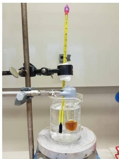
Abbildung 71: Erhitzungsversuch von ^{14}\text{C} -Aspartam in Kaffee, schematische Übersicht
