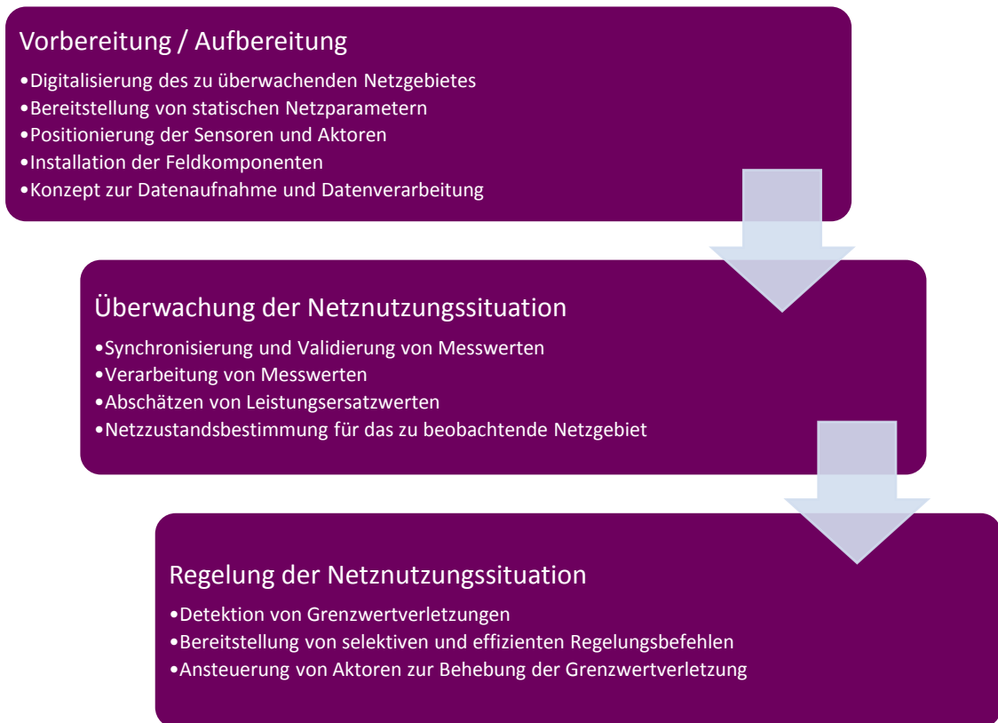
Abbildung 2-6: Darstellung der konsekutiven Prozesse einer Niederspannungsautomatisierung
