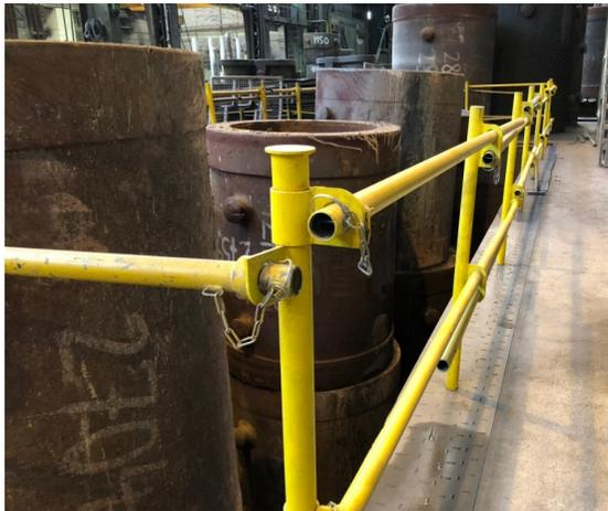
**Abbildung 21: Sicherung der Geißgruben entsprechend dem in der ASR A2.1 niedergeschriebenen Stand der Technik seit Mitte 2016<sup>197</sup>**
