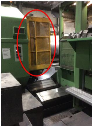
**Abbildung 6: Drehfutterschutz (rot markiert) an einer Horizontal-Großdrehbank<sup>44</sup>**
