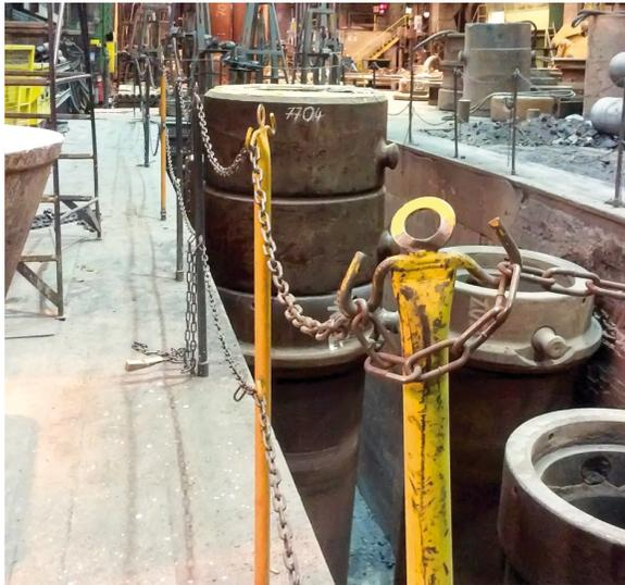
**Abbildung 19: Sicherung der Gießgruben gegen Absturz mittels steckbarer Pfosten in Verbindung mit Ketten bis Mitte 2016<sup>193</sup>**
