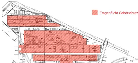
**Abbildung 32: Definierte Bereiche mit einer Gehörschutztragepflicht (gilt für den alltäglichen Produktionsbetrieb)<sup>224</sup>**
