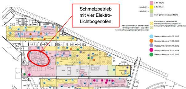
Abbildung 31: Definierte Lärmbereiche (gemäß LärmVibrationsArbSchV)<sup>222</sup>
