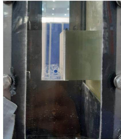
Abbildung 4.2: Einbauten zur Montage der Lasertriangulationssensoren unter Berücksichtigung des zulässigen Messbereichs der Sensoren. Die Höhe der beiden Lasertriangulationssensoren (linke Abbildung) beträgt zusammen 70 mm, die Höhe der in die Filterkammer ragenden Box (rechte Abbildung) beträgt ca. 80 mm.
