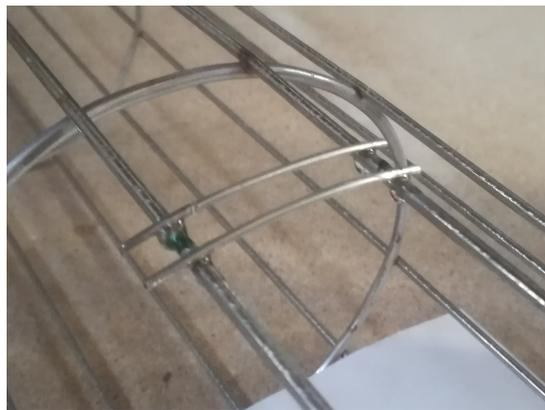
**Abbildung 3.8: Verfeinerung des Stützkorbs zur Minimierung der Verformung des Filtermediums (Durchmesser der Stützkorbdrähte 4 mm)**
