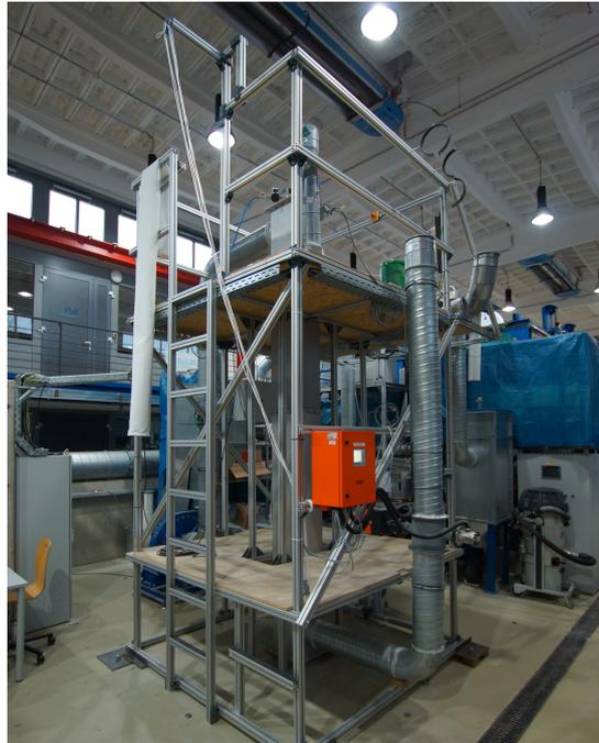
Abbildung 5.1: Filterschlauchteststand (Gesamthöhe des Teststands ca. 4 m)
