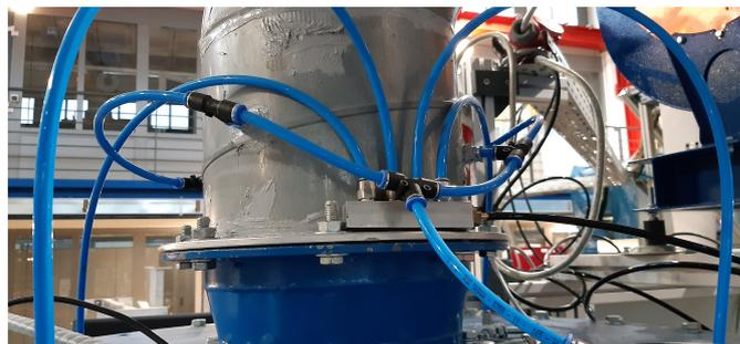
Abbildung 3.6: Ringmessstelle (Durchmesser des Lüftungsrohrs 250 mm)
