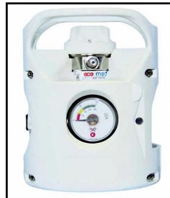
Abbildung 10: Druckminderer für medizinischen Sauerstoff. Im Druckminderer wird das Gas von ca. 200 bar Fülldruck in der Gasflasche auf einen Ausgangsdruck von ca. 3,6 bar reduziert. Der Druck in der Flasche und damit das nutzbare Restvolumen lässt sich anhand des Manometers ablesen. In der Regel kann der Durchfluss des Gases in L/min leicht am Druckminderer eingestellt werden. Quelle: «GCE - Fulda» (linkes Bild)
