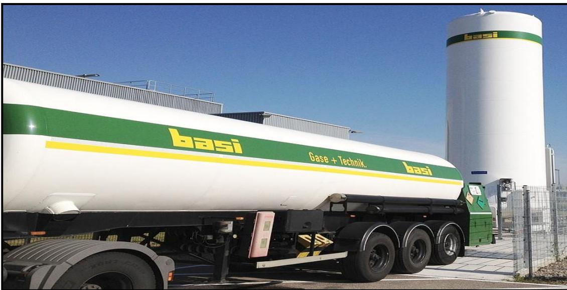
**Abbildung 19:** Tankkraftwagen (TKW) für kälteverflüssigte Gase wie LOX oder LIN. Der Aufleger des TKW weist am hinteren Ende die vorschriftsgemäßen ADR-Kennzeichnungen auf. Quelle: „basi Schöberl“ Bildarchiv
