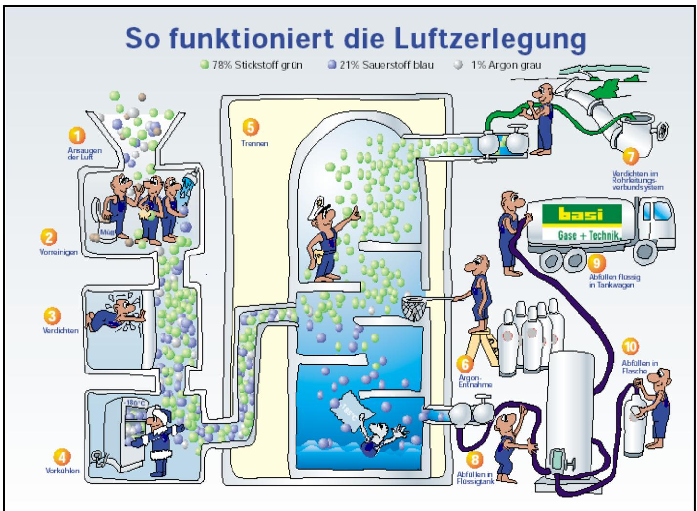
Abbildung 2: Herstellung von medizinischem O<sub>2</sub> mit einer LZA. Quelle: „basigas“ Bilderarchiv.
