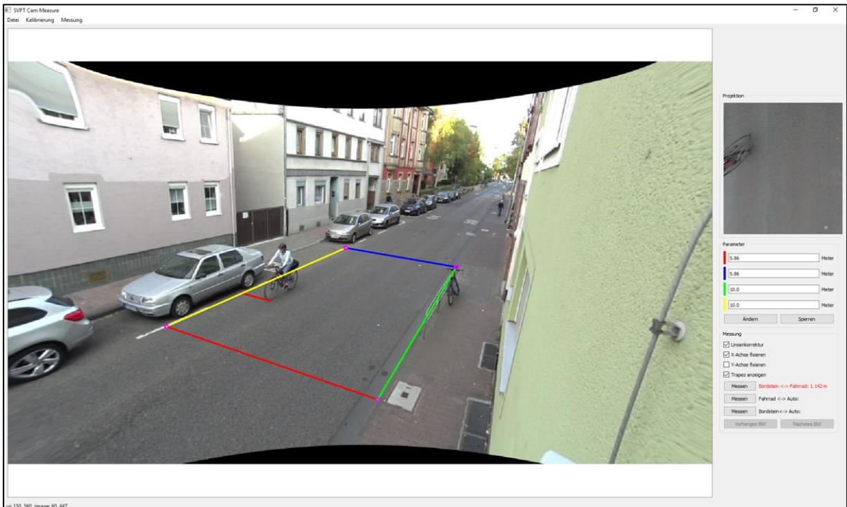
Abbildung 15: Vermessung Fahrlinien mit Mess-Tool SVPT
