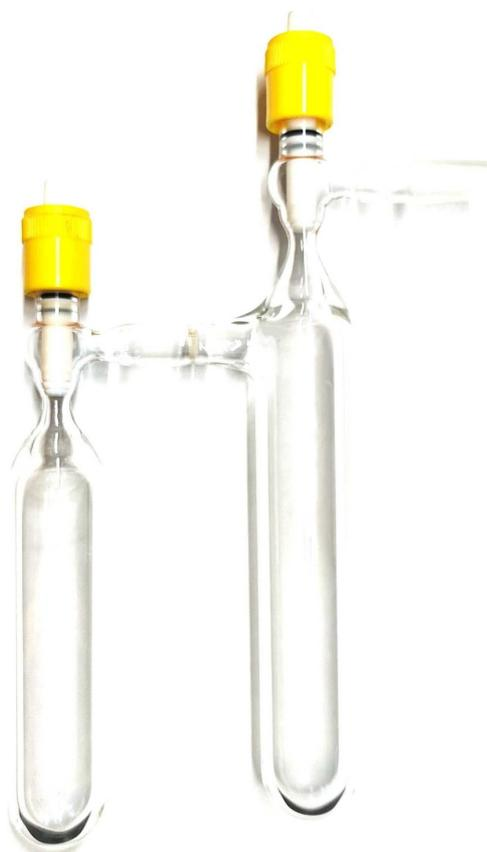
Abbildung 147: Doppelschlenkgefäß mit J. Young-Ventilen und integrierter Glasfritte.
