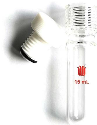
**Abbildung 148:** Dickwandiges Glasgefäß der Firma Synthware® (15 ml Fassungsvermögen) mit PTFE-Verschlusskappe und Viton® O-Ring Dichtung.
