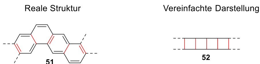
Abbildung 37: Vereinfachte Darstellung der Leiterpolymerstruktur, links das reale Pentaphen-Leiterpolymer 51 und rechts die vereinfachte Darstellung einer „Leiter“.
