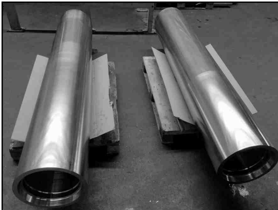
Abbildung 137: Industriell hergestellte Verbundgussrohre aus dem kommerziellen Stahl 1.4581 (GX2CrNiMoNb19-11-2) und dem Stahl 5Mo-2W im Zustand nach der mechanischen Bearbeitung (Fertigbearbeitung).
