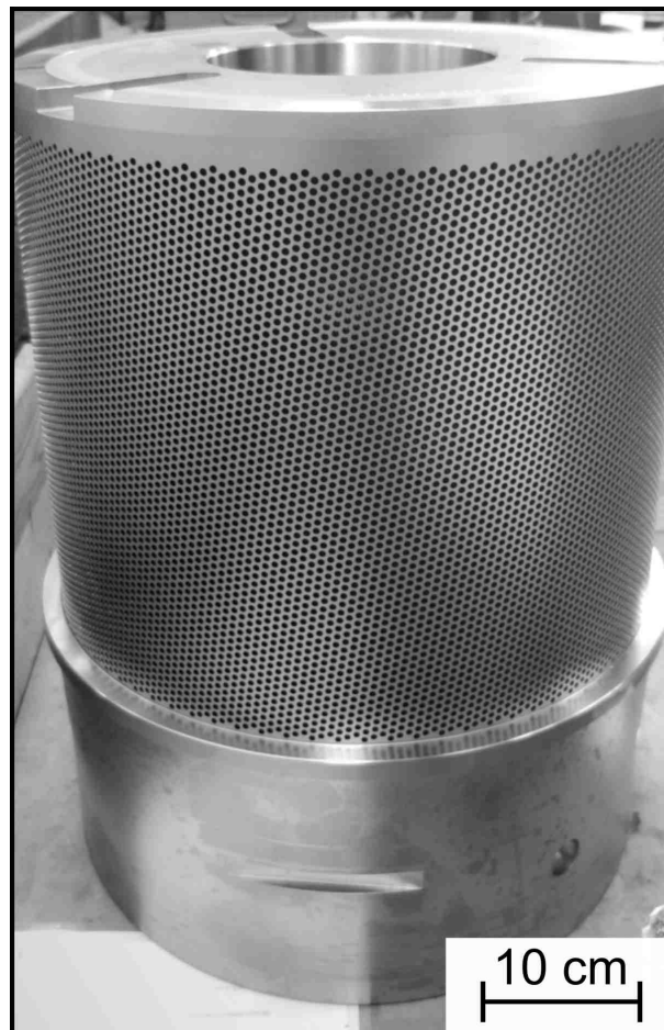
Abbildung 72: Demonstrator (Separationstrommel) aus dem neu entwickelten Stahl GX30 für die Anwendung in der Lebensmittelindustrie.
