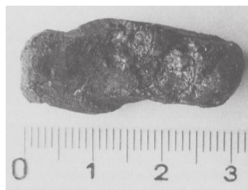
Bild 15: Fremdkörper, der nach einer Staubexplosion in einem Mühlenbunker gefunden wurde [Bartknecht und Zwahlen 1993, S. 389]
