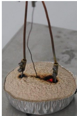
Bild-B 5: Entzündung der Staubschicht im Bogenbereich des Hd
