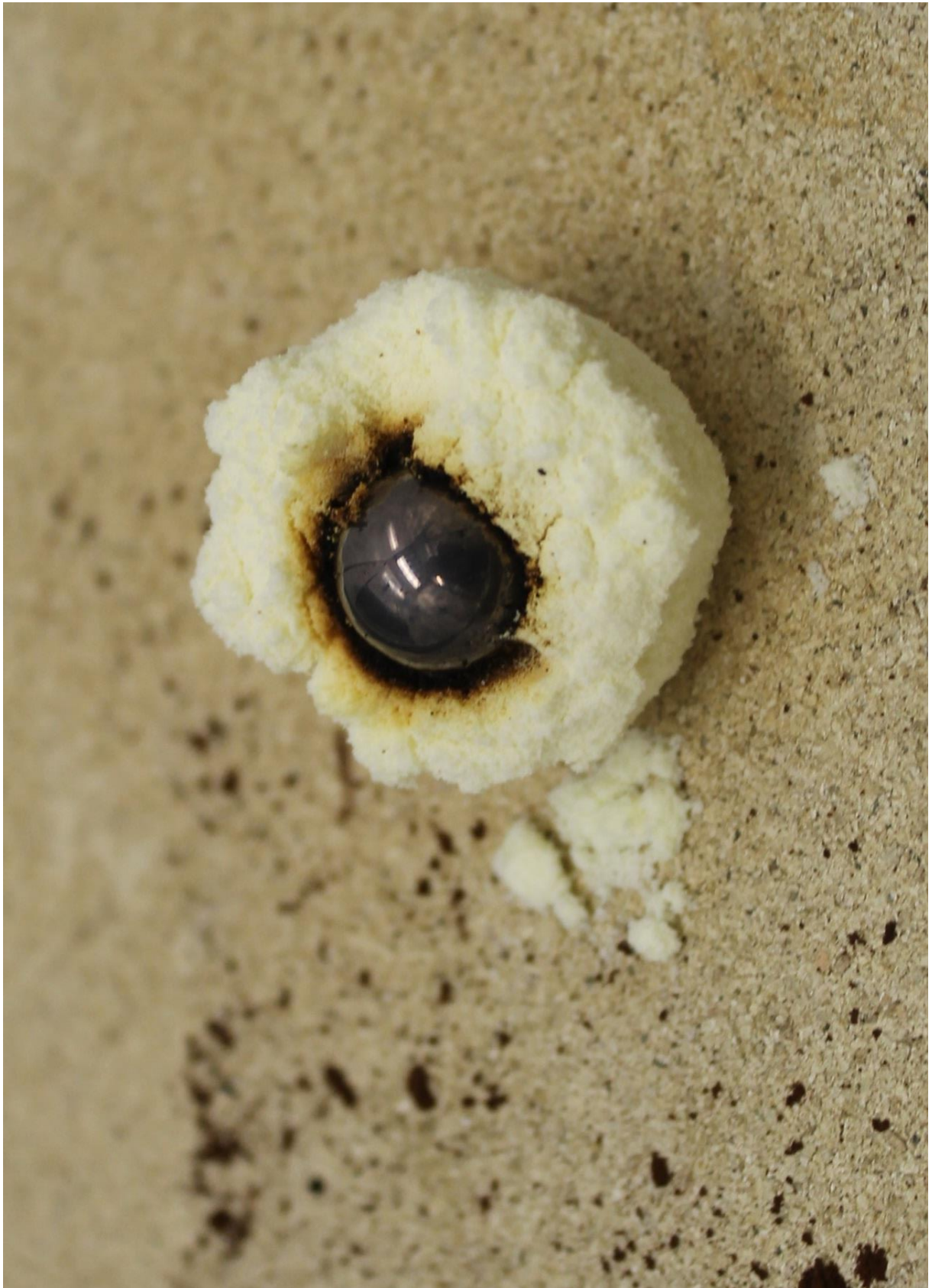
Bild-A 6: Feste Agglomeration des Milchpulvers nach der Bestimmung mit einer Kugel \varnothing = 15 mm
