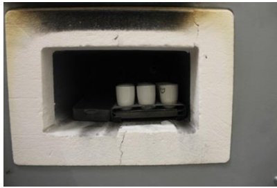
Erwärmung der iHZZP inkl. Tiegel im Ofen
