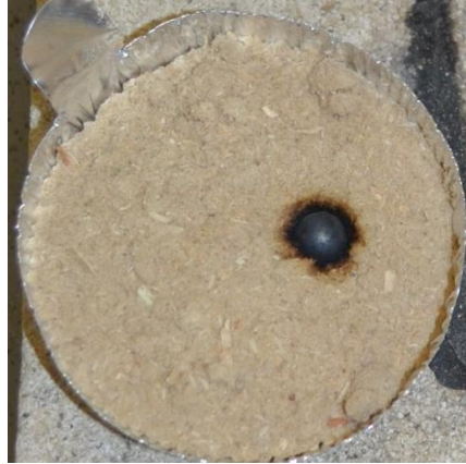
Bild 52: Verkohlung im Randbereich eines iHVP ohne Entstehung eines selbstständigen Schwelbrands im Yellow Pine Staub
