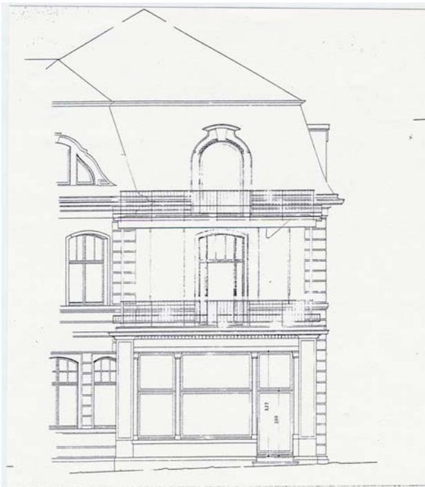
Abb.403: Haus Wichelhaus, Aufriss der nördlichen Seitenfront mit den baulichen Änderungen für eine Terrasse im Dachgeschoss, 1970
