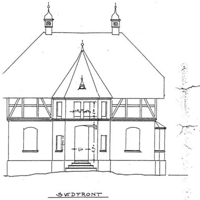
Abb.306: Sommerhaus H. Plange, Aufrisszeichnung der Eingangsfassade, 1898
