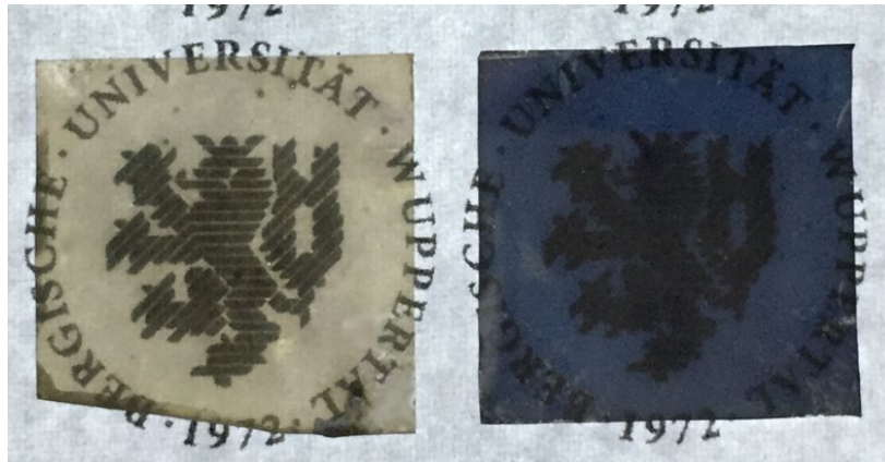
Abbildung 3.11 Vergleich der modifizierten ELD-Lösung auf mittels O_2 -Plasma behandelten PDMS-Oberflächen. Die Oberflächen der Substrate sind gleichbehandelt. Die Abscheidung der linken Probe erfolgte mit der ELD-10A-Lösung, rechts mit ELD-SES.
