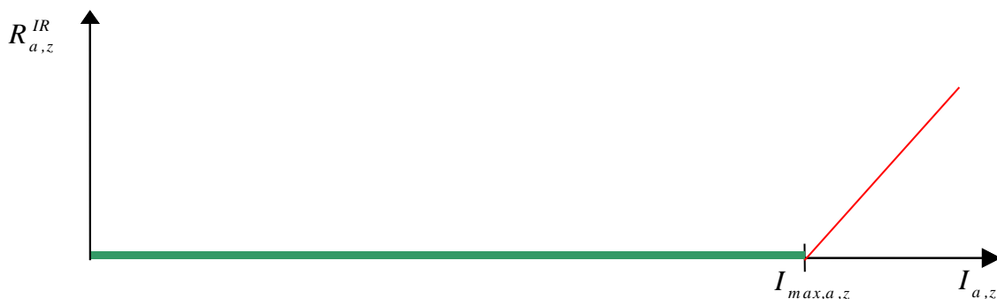
Bild 3.2: Verlauf der Stromrestriktion auf einen Zweig z
