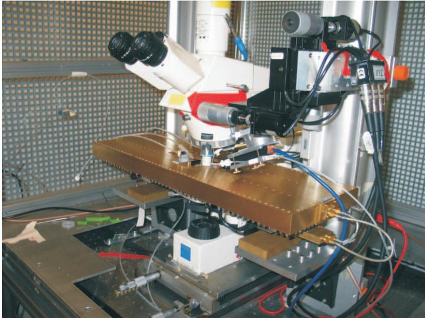
Abbildung 3.29: Montierte Expositionsanlage am Beispiel *GSM900*.
