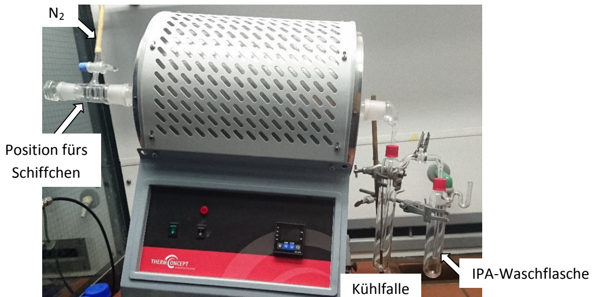
Abbildung 96: Aufbau der Ofenpyrolyse
