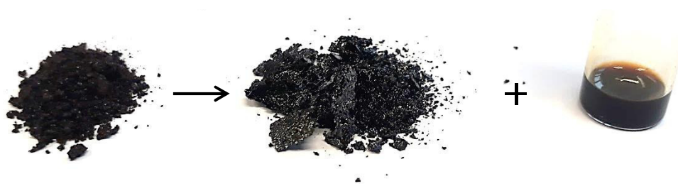
Abbildung 67: Organosolv-Lignin, Organosolv-Kohle und Pyrolyseöl nach Pyrolyse bei 500 °C
