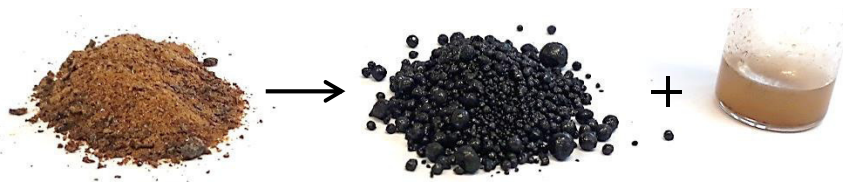
Abbildung 82: Lignosulfonat, Lignosulfonat-Kohle und Pyrolyseöl nach Pyrolyse bei 500 °C
