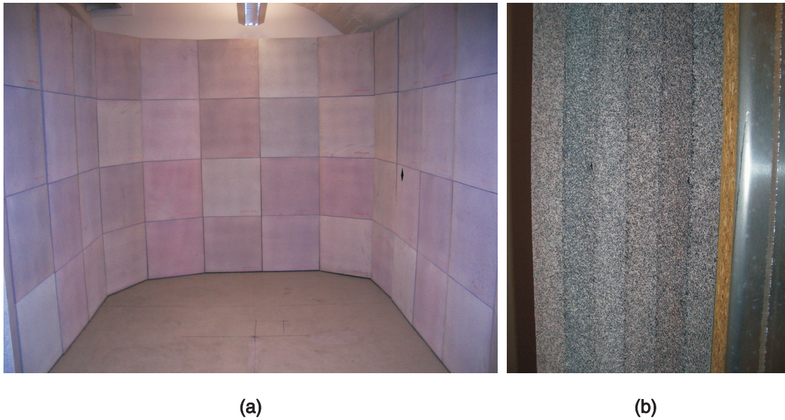
Abbildung 5.3: (a) Foto des mit Absorbermaterial abgetrennten Messplatzes, (b) Detaillierte Aufnahme einer geschichteten Absorberwand.
