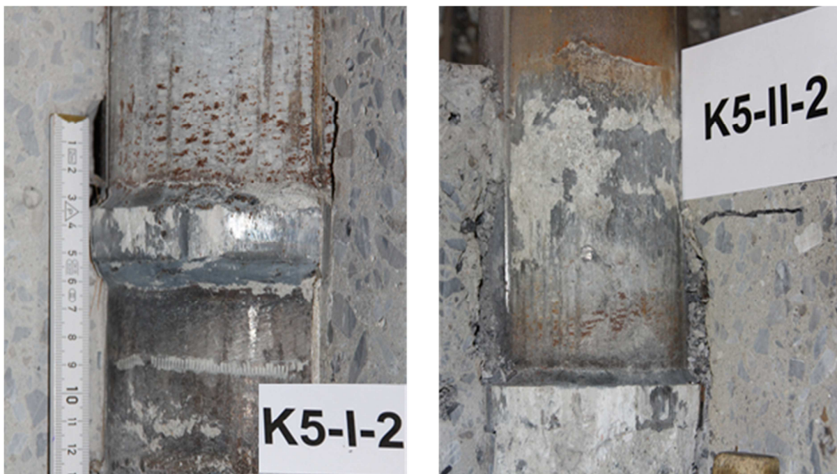
Abb. 39: Verschiebung im Beton bei Versuchsreihe K5
