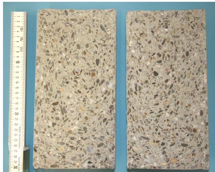
Abb. 31: Längsschnitt einer Zylinderprobe des Betons [3]
