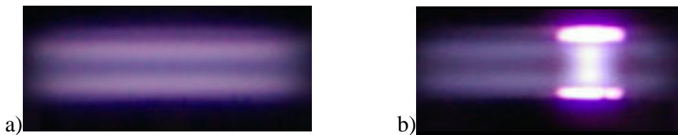
Abb. 4.10: Bildaufnahmen von CCRF-Entladungen in einem lufthaltigen He-Gasgemisch: a) abnormale \alpha -Entladung, b) parallel brennende abnormale \alpha - sowie normale \gamma -Entladung. Elektrodenabstand 1,5 mm, Elektrodendurchmesser 5 mm.
