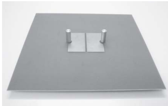
Abbildung 4.16: Foto der experimentell untersuchten Struktur [33]. Monopollänge l = 23,2 mm, Monopolabstand a = 63,3 mm, Breite der Mikrostreifenleitung w = 58,8 mm, Schlitzbreite g = 2,9 mm, Abstand zw. Leitung und Antennenfußpunkt s = 6,2 mm.
