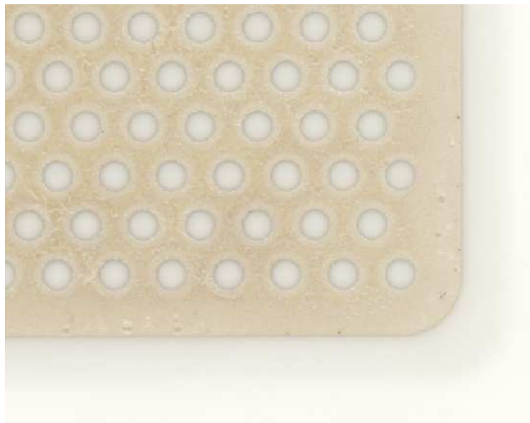
Abbildung 4.10: Die Elektrode mit Lochstruktur nach 8 h Betrieb in N_2 -Plasma (zum Vergleich mit der Streifenstruktur, siehe Abb. 4.5 b)
