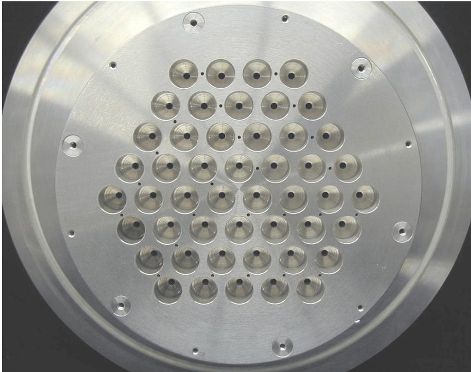
*Die komplett aus Aluminium gefertigte Plasmaquelle HCD-P100 mit planar angeordneten Öffnungen für die Erzeugung von 48 Plasmajets. Zusätzlich ist in der Plasmaquelle HCD-P100 die Monomergaszuführung integriert.*
