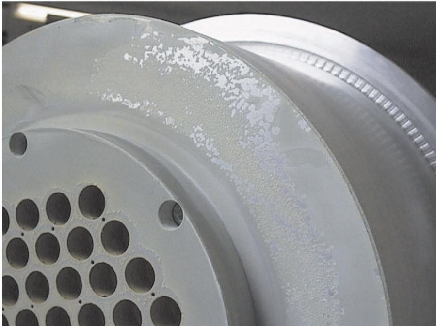
*Dargestellt ist hier die parasitäre Schichtbildung an einer planaren Plasma-Jet-Quelle des Typs HCD. Deutlich sichtbar die Verschmutzungen an der Quelle. Diese Partikelbildung kann zu Verschmutzungen der zu beschichtenden Targets führen.*
