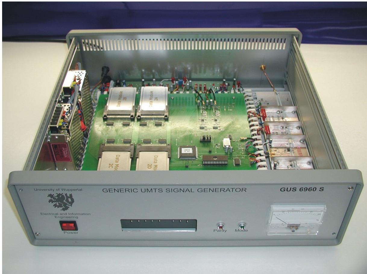
Abb. 4.2-7: Ansicht des Generischen UMTS-Testsignalgenerators mit abgenommenem Gehäusedeckel
