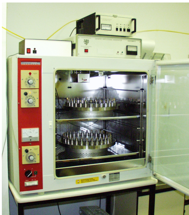
Abb. 4.4-27: Versuchsaufbau mit Inkubator, 2 Wellenleitungen, Signalgenerator und Verstärker
