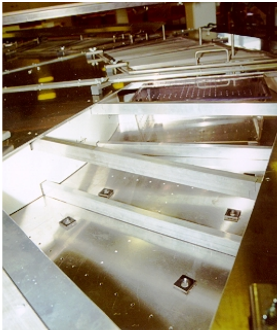
Abb. 4.5-21: a) Metallstege im Expositionsbereich mit Käfigen b) Versorgung der Tiere mit Wasser: Trinkstutzen der Tränkflaschen werden über Dämpfungskamine in die Käfige geführt.
