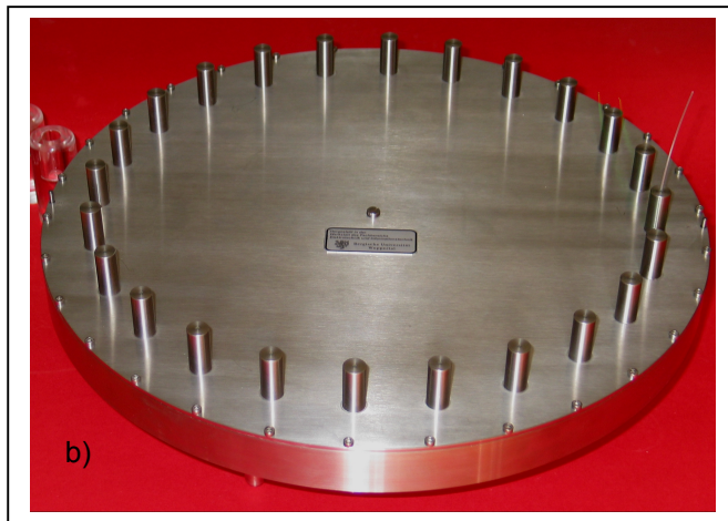
Abb. 4.4-4: Aufbau der radialen Wellenleitung für Experimente mit isolierten Pinealorganen a) Konstruktionszeichnung (Maße in mm) b) Foto einer Expositions-kammer mit Dämpfungskaminen c) Geöffnete Expositions-kammer mit Tefloneinsatz
