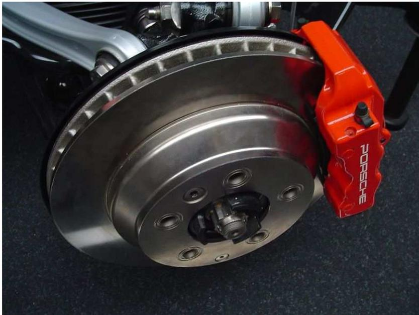
**Bild 2-7: Innenbelüftete Scheibenbremse mit Bremssattel (rot) /wik 03/**
