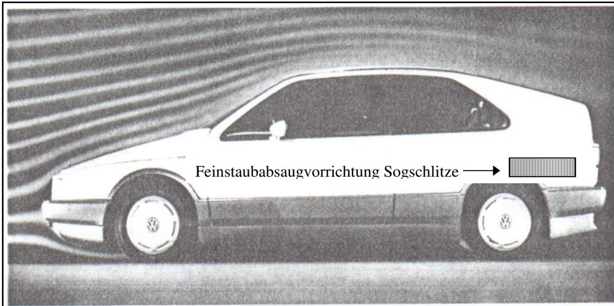
Abbildung 3.33: Platzierung der Feinstaubabsaugvorrichtung an einem Pkw (Anwendungsbeispiel, Foto nach Volkswagenwerk AG, Wolfsburg).
