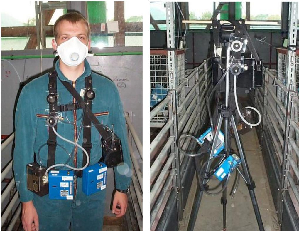
**Abbildungen 2-7: Probenahme mit dem PGP-System, personengetragen und stationär**
