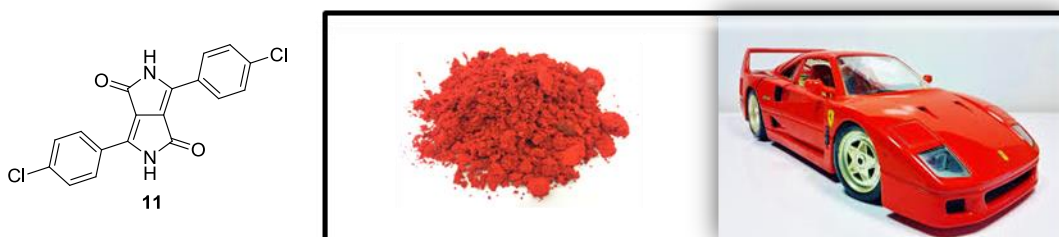
Abbildung 3 Chemische Struktur des Pigmentes ‘‘Ferrari-Rot‘‘ (links), Photographie eines DPP-Derivats im Festkörper (Pulverform, mittig); sowie Photographie eines Ferrari mit typischem roten, DPP-basierten Lack 5
