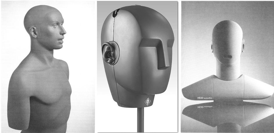
Bild 3.35: Kunstkopftypen (Knowles Kemar, Neumann KU100, Head-Acoustics HMS II)
