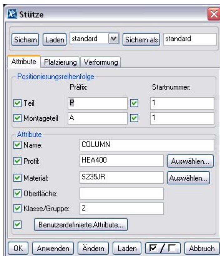
Abb. 44: Tekla Structures Dialogfenster „Stütze“
