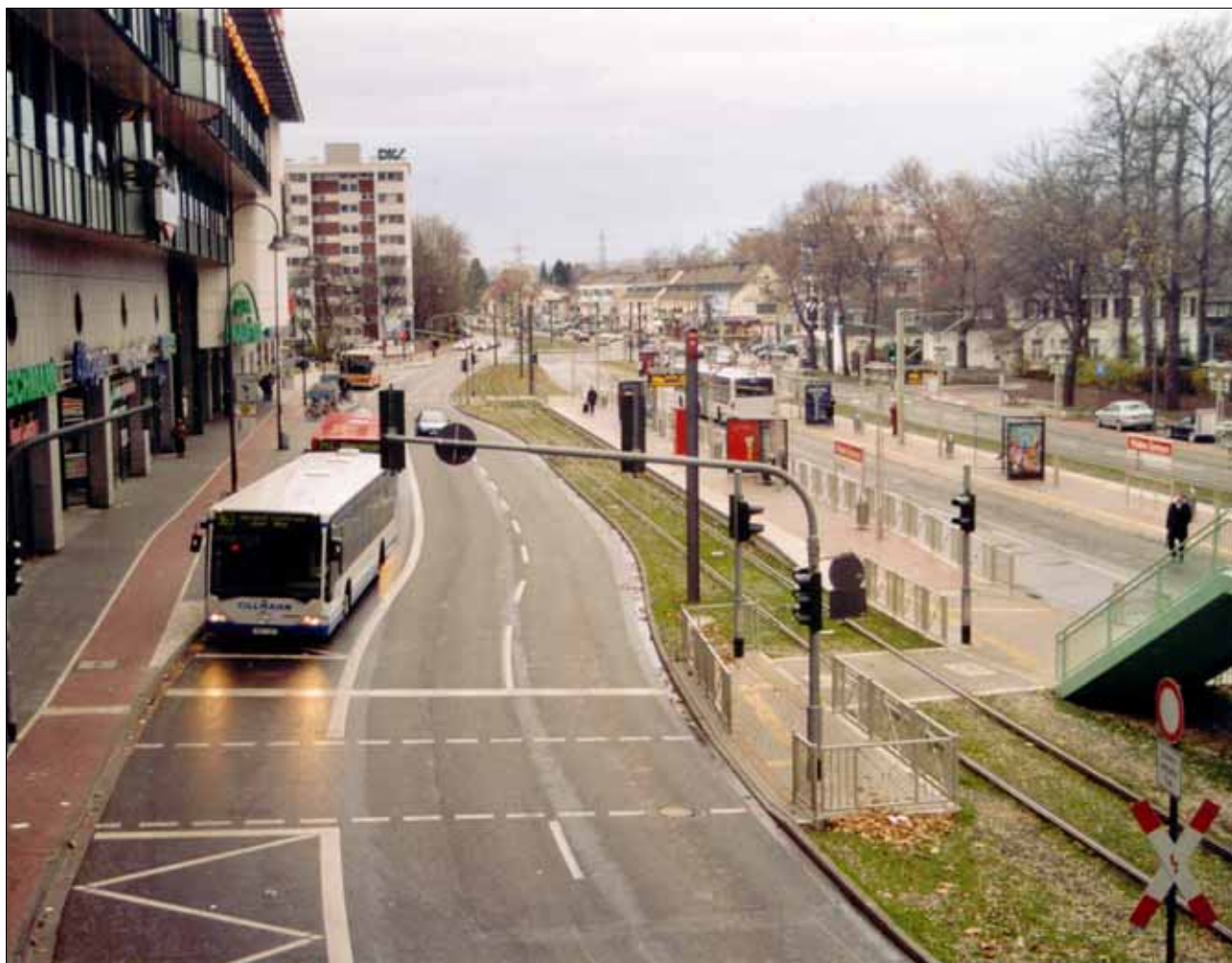
Abb. 105: Neue Verknüpfungshaltestelle in Köln anno 2002 – Umsteiger zwischen Bus und Stadtbahn müssen entweder die Straße queren oder finden den direkten Weg zwischen innenliegendem Bussteig und Bahnsteig Richtung Zentrum (links) durch einen Zaun versperrt. Witterungsschutz für die Umsteiger existiert nicht.
