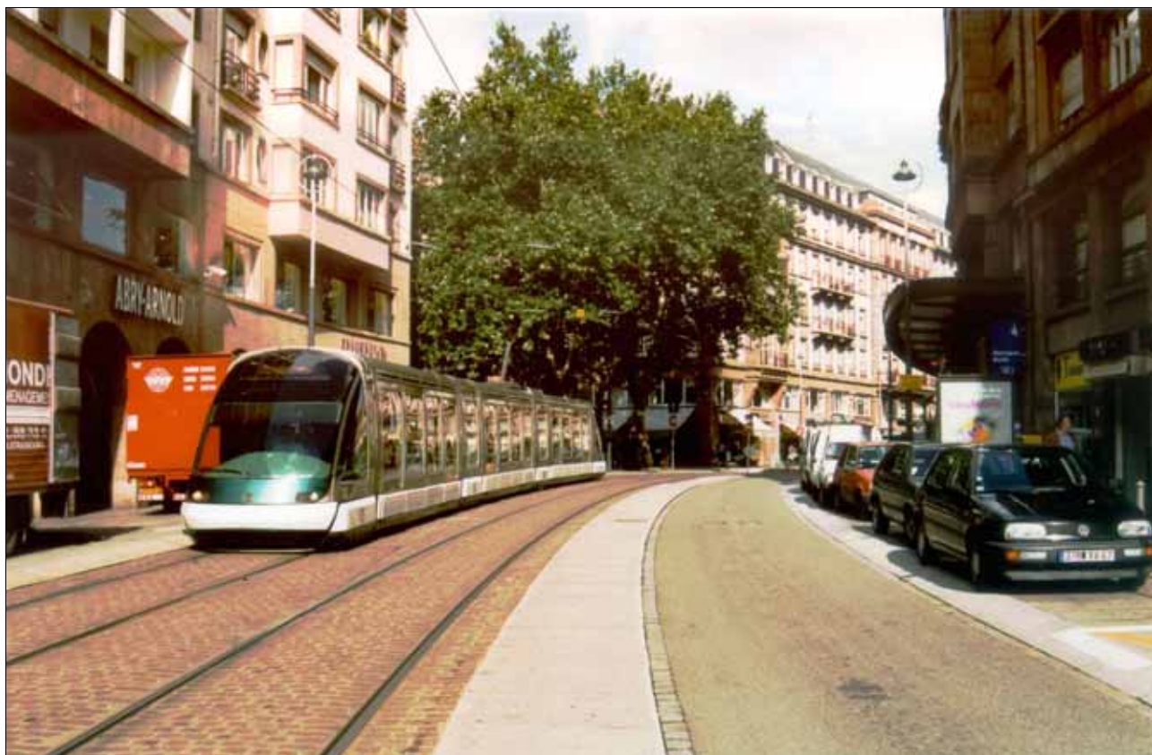
Abb. 65, 66: Selbst in engen, gewachsenen Straßenräumen lassen sich durch Beschränkung des Kraftfahrzeugverkehrs in eine Richtung stadtverträgliche besondere Bahnkörper schaffen; die Konsequenz, wie diese Form der Bevorrechtigung von Straßenbahnstrecken in Frankreich umgesetzt wird, ist beeindruckend und nachahmenswert. Die Bilder zeigen ähnlich breite Straßenräume in Köln mit der klassischen Führung einer Straßenbahntrasse in Mittellage mit seitlichen Parkständen (und Verkehrsbehinderungen zwischen MIV und ÖPNV) sowie in Straßburg mit einbahnigem Rückbau der Straße zur Anlage eines besonderen Bahnkörpers, der problemlos noch Anlieferverkehr erlaubt.
