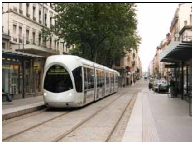
Abb. 70, 71: Besondere Bahnkörper in engen Straßenräumen mit dichter städtischer Bebauung – Beispiele Grenoble und Lyon
