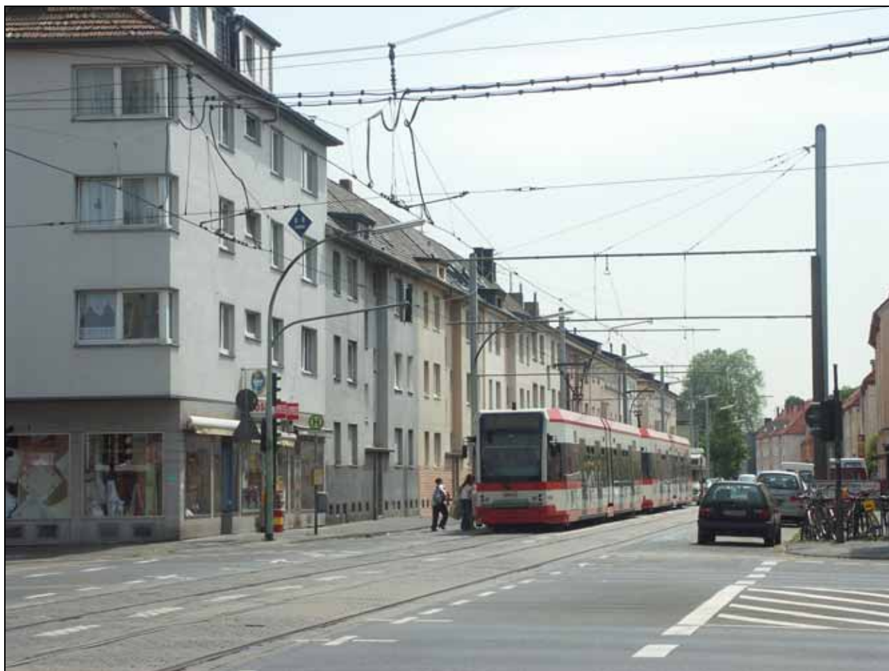
Abb. 156: Hochkettenfahrleitung sind in engen Straßenräumen sehr problematisch, Beispiel Köln
