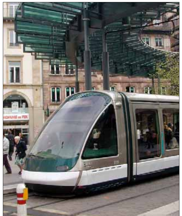
Abb. 219: Eurotram, Kopfgestaltung mit Kameras statt Rückspiegeln
