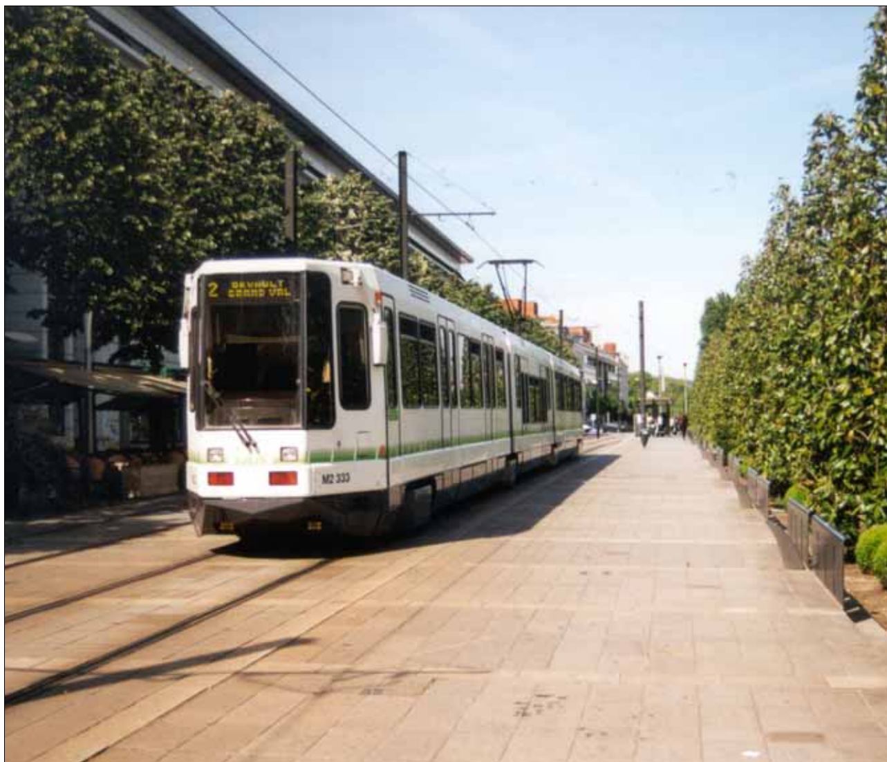
Abb. 108: Nantes – Straßenbahn im fußgängerfreundlich gestalteten Bereich, nachgespannte Einfachfahrleitungen beeinträchtigen die Optik kaum
