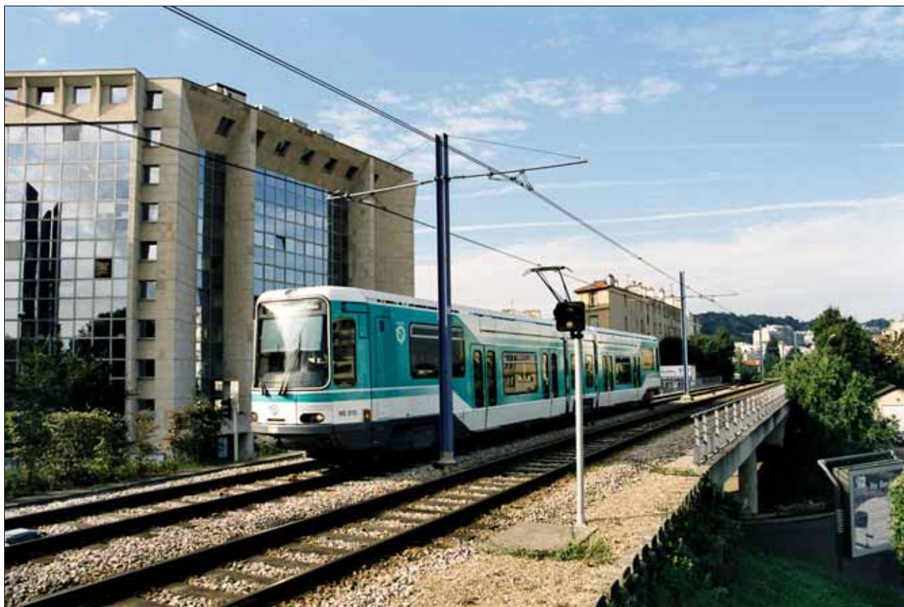
Abb. 38: Keine Zweisystemstadtbahn, aber Tram-Train im weitesten Sinne – Straßenbahn auf umgewidmeter Eisenbahntrasse in Paris
