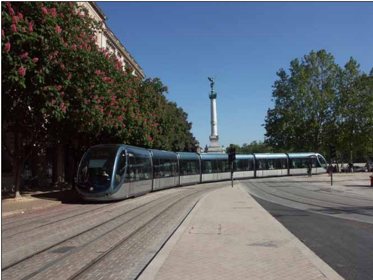
Abb. 164: Bordeaux, erste Straßenbahn der Welt mit der unterirdischen Stromversorgung APS
