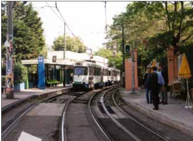
Abb. 109: Marseille – die Unterleitung nach System Innorail im Testbetrieb (rechtes Gleis)
