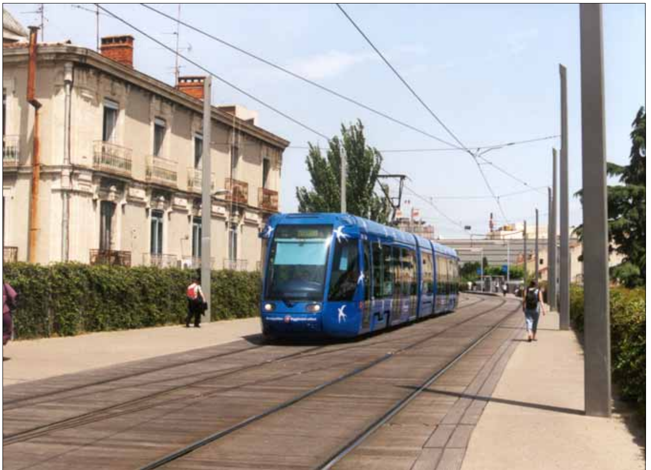
Abb. 73, 74: Eigene Bahnkörper und parallel geführte Fuß- und Radwege – Beispiele Grenoble und Montpellier. Die Bahnkörper sind wenig bis gar nicht vom Fußgängerbereich separiert.
