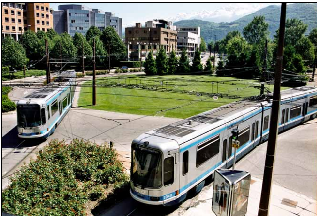
Abb. 161: TFS 2 von 1987 in Grenoble, das erste Designer-Straßenbahnfahrzeug der Welt auf dem ersten komplett niederflurgerecht ausgebauten Straßenbahnnetz der Welt; man beachte etwa hinsichtlich des Fahrzeugdesigns die sorgsame Verkleidung der technischen Ausrüstung im Dachbereich
