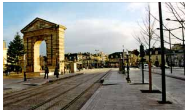
Abb. 112: Bordeaux, Einbindung einer Straßenbahntrasse ohne Oberleitung in eine Platzfläche
