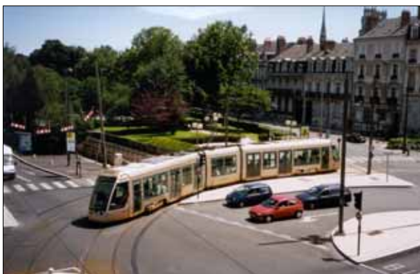
Abb. 224: Citadis Orléans, man beachte die äußerst ansehnliche Dachpartie mit weitgehend abgeblendeter technischer Ausrüstung
