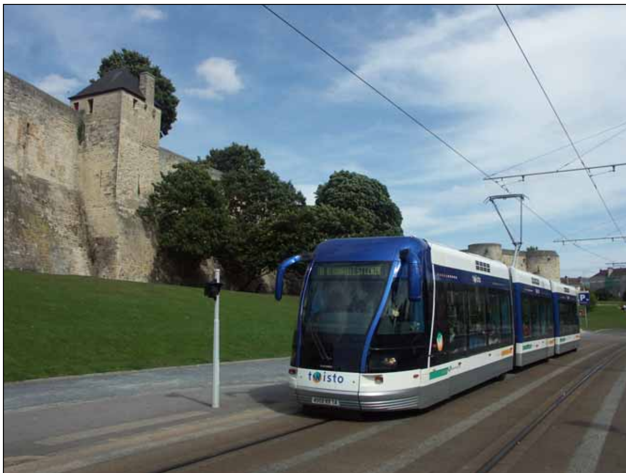
Abb. 37: GLT in Caen – im Gegensatz zu Nancy wird hier auf ganzer Linie spurgeführt elektrisch gefahren
