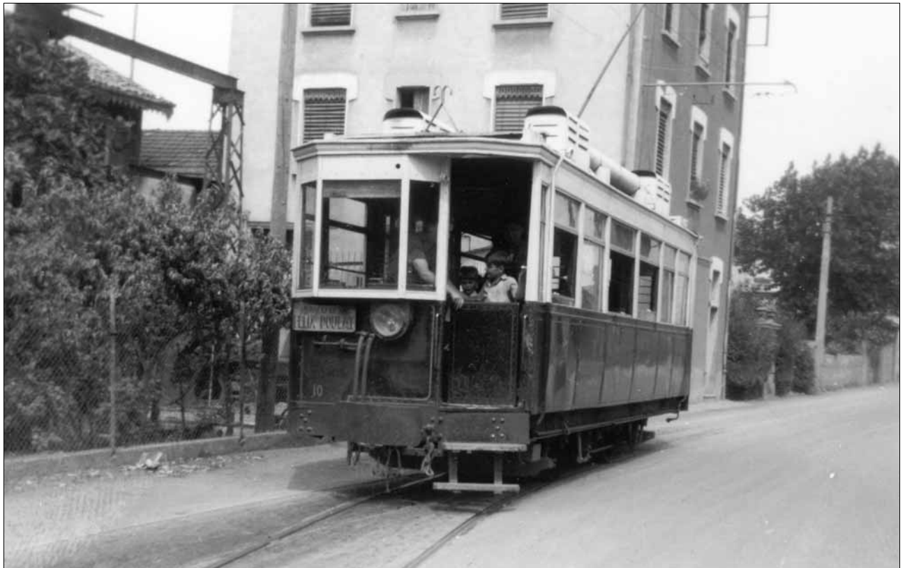
Abb. 10: Straßenbahn mit einfachstem Ausbauzustand in Grenoble, 1948 vier Jahre vor der Gesamtstilllegung. Das Bild lässt erahnen, warum man nach dem zweiten Weltkrieg in den allermeisten Fällen den Aufwand einer Modernisierung der Straßenbahnsysteme scheute.
