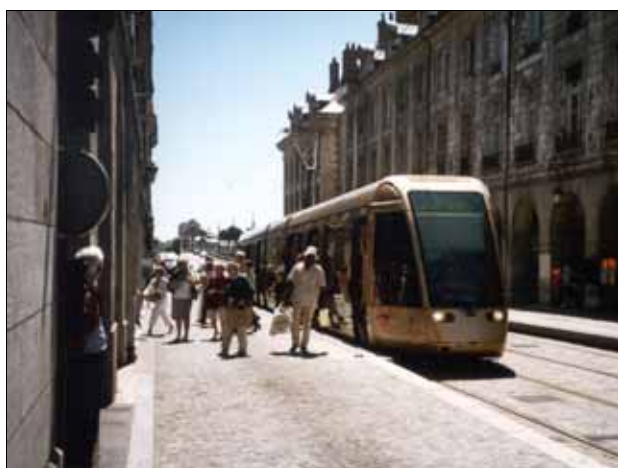
Abb. 101: Die vom Zentrum zur Loire führende Strecke in Orléans ist eingepflastert und kann abschnittsweise vom Straßenverkehr mitbenutzt werden. Für Fußgänger stehen in der durchfahrenen Rue Royale Arkadengänge zur Verfügung. An der Station Royale-Châtelet sind die Bahnsteige gleichzeitig Straßenfahrbahn. Ampeln und Schranken sichern die Ein- und Aussteigevorgänge.
