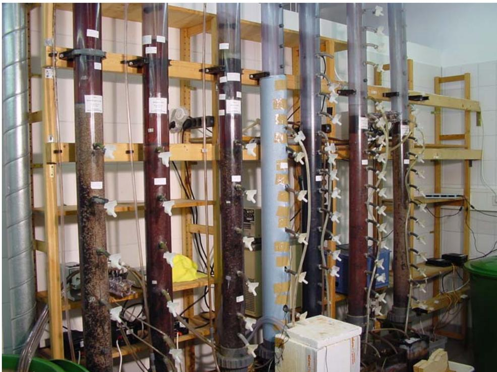
Abbildung 4.5 Nitrifikationsanlagen im Technikum
