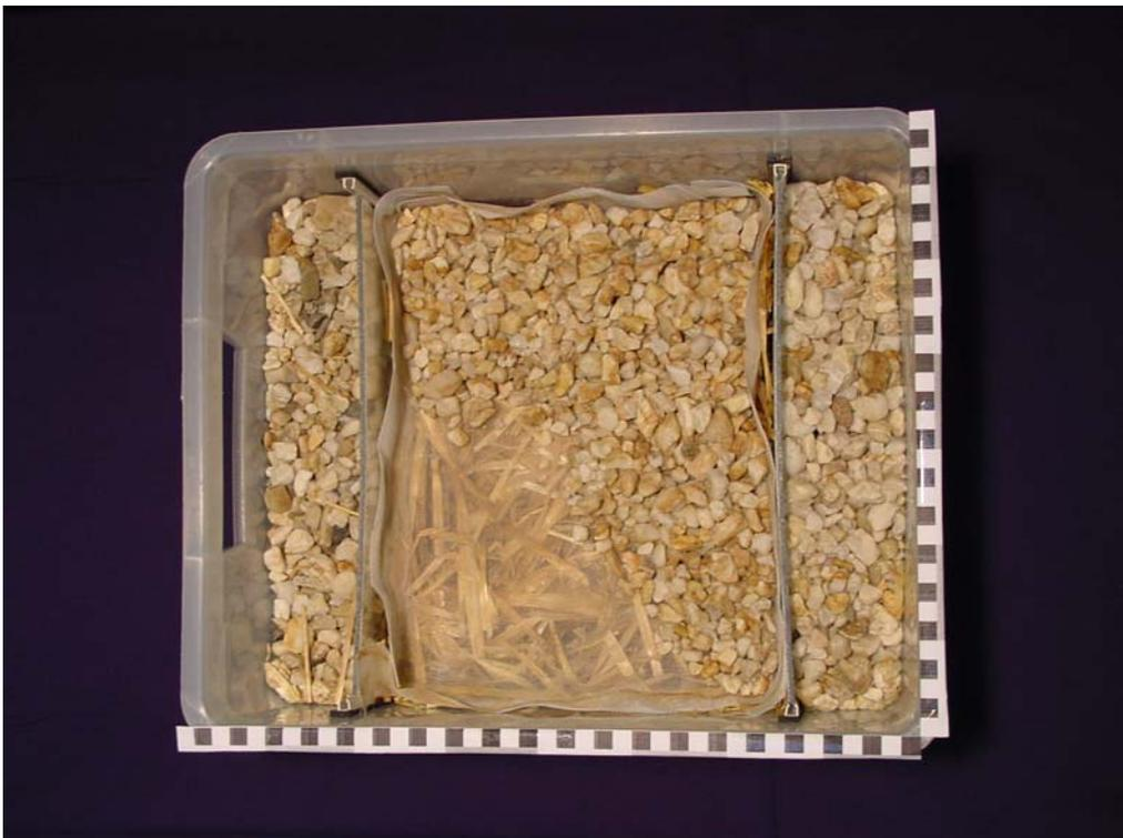
Abbildung 4.12 Versuchsbehälter Langzeituntersuchung mit Stroh und Kies sowie Abdeckung
