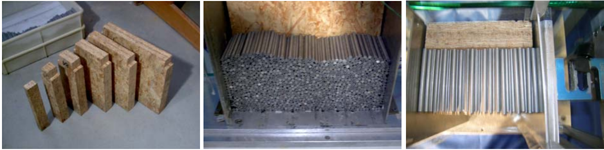
Abb. 4-3: Distanzstücke (links), Einbau des Schneebeli-Modells (Mitte und rechts)
