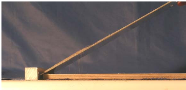
Abb. 2-14: Versuchsaufbau zur Bestimmung des Reibungsbeiwertes Sand - Aluminium
