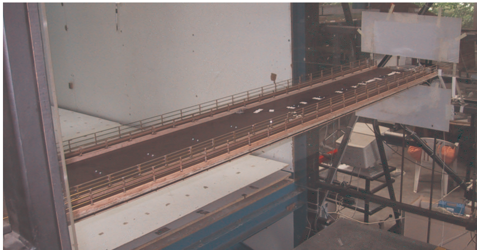
Abb. 1.7: Sectionmodell im Grenzschicht-Windkanal der RWTH Aachen
