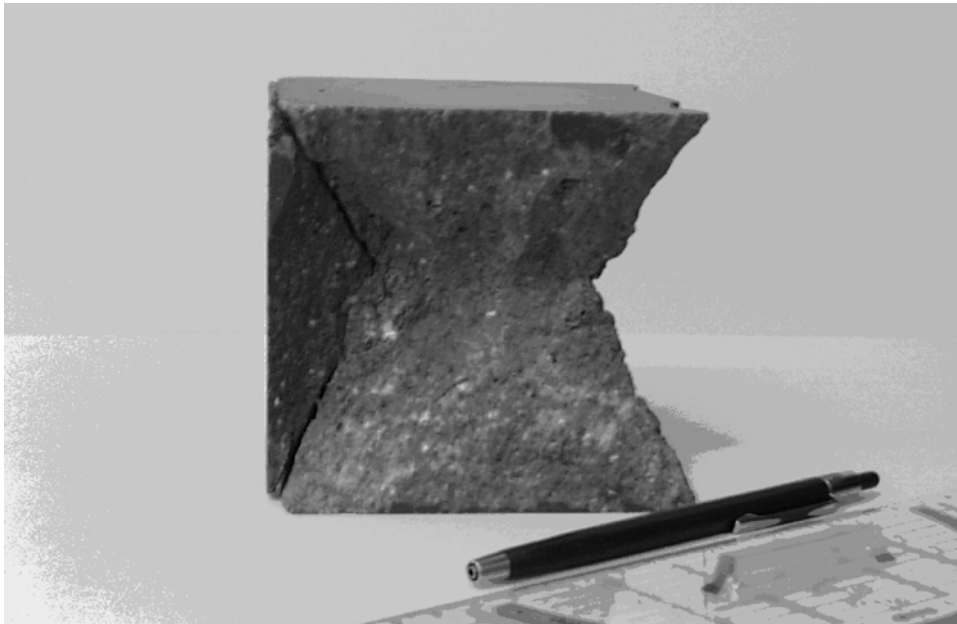
Bild 3.48: Probe eines einachsigen Druckversuches nach der Versuchsdurchführung
