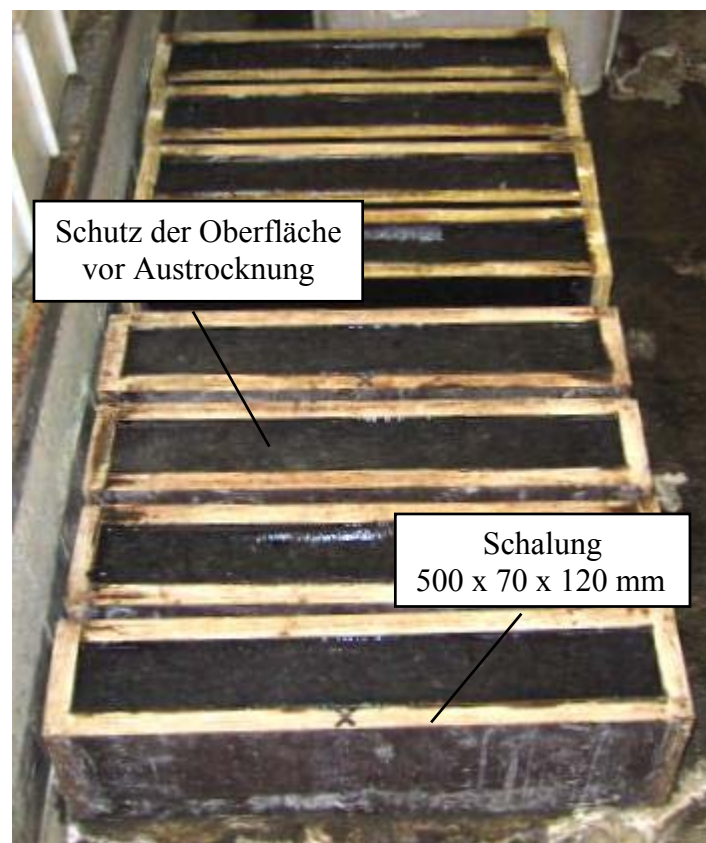
Abbildung 7.17: Foto der Schalungen
