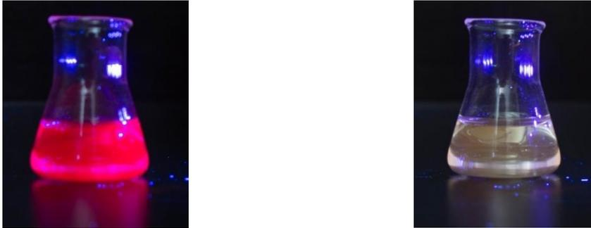
Abb. 59: In **Aceton**, links: Fluoreszenzemission einer Merocyanin-Lösung (ME) ( $c(\text{SP}) = 5 \cdot 10^{-5} \text{ mol/L}$ ) bei Bestrahlung mit UV-Licht ( $\lambda = 365 \text{ nm}$ ), rechts: Fluoreszenzemission einer sauren Merocyanin-Lösung ( $\text{MEH}^+$ ) ( $c(\text{SP}) = 5 \cdot 10^{-5} \text{ mol/L}$ ,  $c(\text{TCA}) = 5 \cdot 10^{-2} \text{ mol/L}$ )
