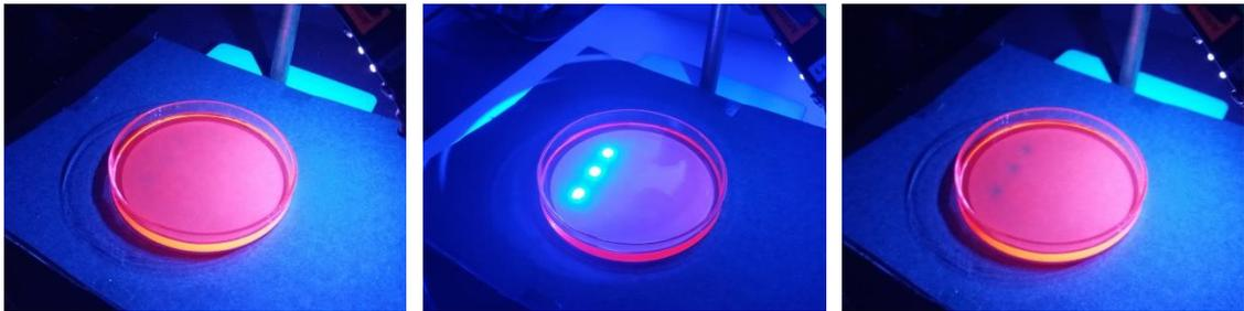
Abb. 118: Durchführung des RESOLFT-Modellversuchs (v.l.n.r.): „AN“-schalten der Probe mithilfe von UV-Licht ( $\lambda = 365 \text{ nm}$ ), „Desaktivieren“ bestimmter Regionen mithilfe von blauem Licht ( $\lambda = 450 \text{ nm}$ ), „Auslesen“ des Ergebnisses unter UV-Licht ( $\lambda = 365 \text{ nm}$ )
