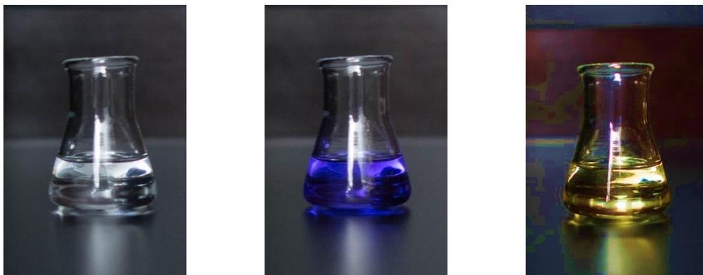
Abb. 55: Links: farblose unbestrahlte Spiropyran-Lösung (SP) in TCM ( $c = 5 \cdot 10^{-5}$  mol/L); Mitte: Merocyanin-Lösung (ME) ( $c(\text{SP}) = 5 \cdot 10^{-5}$  mol/L) in TCM nach Bestrahlung mit UV-Licht ( $\lambda = 365$  nm, 30 s); Rechts: angesäuerte Merocyanin-Lösung (MEH<sup>+</sup>-Spezies) in TCM erhalten nach Bestrahlung einer sauren Spiropyran-Lösung ( $c(\text{SP}) = 5 \cdot 10^{-5}$  mol/L,  $c(\text{TCA}) = 5 \cdot 10^{-2}$  mol/L) mit UV-Licht ( $\lambda = 365$  nm, 30 s)
