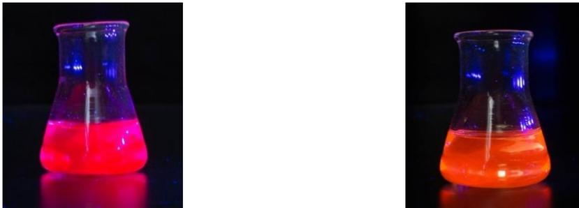
Abb. 56: Links: Fluoreszenzemission einer Merocyanin-Lösung (ME) in TCM ( $c(\text{SP}) = 5 \cdot 10^{-5} \text{ mol/L}$ ) bei Bestrahlung mit UV-Licht ( $\lambda = 365 \text{ nm}$ ), Rechts: Fluoreszenzemission einer sauren Merocyanin-Lösung ( $\text{MEH}^+$ ) in TCM ( $c(\text{SP}) = 5 \cdot 10^{-5} \text{ mol/L}$ ,  $c(\text{TCA}) = 5 \cdot 10^{-2} \text{ mol/L}$ )
