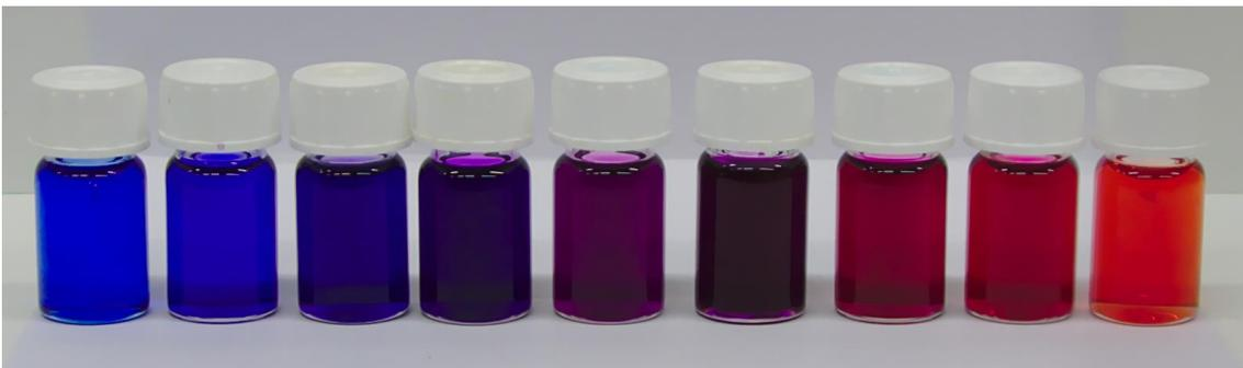
Abb. 46: Farbe von Merocyanin-Lösungen in verschiedenen Lösemitteln (v.l.n.r.: Toluol, Tetrahydrofuran, Chloroform, Aceton, Acetonitril, Dimethylsulfoxid, Ethanol, Methanol und Ethylenglykol; Merocyanin wurde (außer in Ethylenglykol) erhalten durch Bestrahlung mit UV-Licht ( $\lambda = 365 \text{ nm}$ , 30 s).
