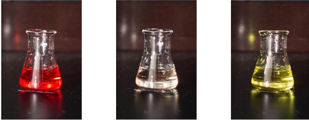
Abb. 62: In **Ethylenglykol**, Links: unbestrahlte Merocyanin-Lösung (ME) ( $c = 5 \cdot 10^{-4}$  mol/L); Mitte: Spiropyran-Lösung (SP) ( $c(\text{SP}) = 5 \cdot 10^{-4}$  mol/L) nach Bestrahlung mit grünem Licht ( $\lambda = 530$  nm, 30 s); Rechts: angesäuerte Merocyanin-Lösung ( $\text{MEH}^+$ ) nach Bestrahlung einer sauren Spiropyran-Lösung ( $c(\text{SP}) = 5 \cdot 10^{-4}$  mol/L,  $c(\text{TCA}) = 5 \cdot 10^{-2}$  mol/L) mit UV-Licht ( $\lambda = 365$  nm, 30 s)
