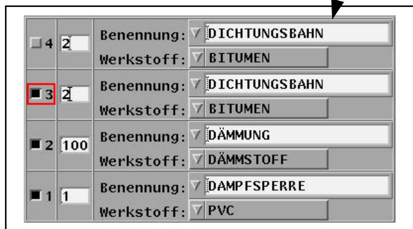
Bild 82: aufgeklappter Bereich aus Bild 81
