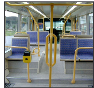
Bild 95d: Fahrzeugtyp 70%-NF-Straßenbahn, Bauart Citadis 301. Es kommen konventionelle Triebdrehgestelle mit durchgehender Radsatzwelle zum Einsatz. An den Fahrzeugenden sind kleine Stufen (180 mm) zu akzeptieren.
