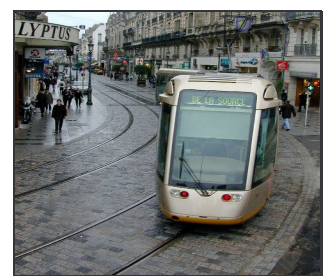
Bild 124: Fahrzeugüberhänge und Wagenkastenauslässe bedingen auch bei Verjüngung der Fahrzeugenden Mehrbreiten bei der Kurvenfahrt.
