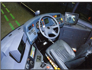
Bild B.32: Fahrer Arbeitsplatz des Civis mit den Funktionsanzeigen, man beachte die Kamera zur Streckenerfassung vor der Frontscheibe. (RENAULT V.I.)
