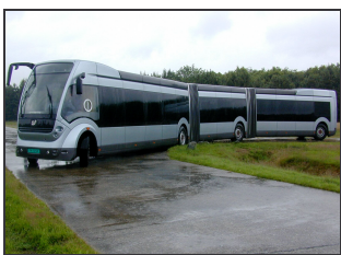
Bild 58: Busbahn Phileas, APTS, in der Doppelgelenkversion auf der Eindhovener Versuchsstrecke
