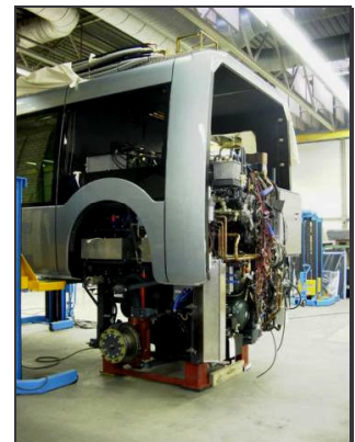
Bild 105c: Einbau eines gas-elektrischen Power-Packs einer Busbahn, Bauart Phileas. Es werden gänzlich neue Anforderungen an das Werkstättenpersonal gestellt. (APTS)
