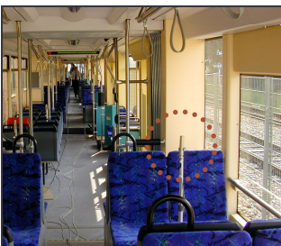
Bild 98: Inbetriebnahme eines Straßenbahnfahrzeugs mit Messung des Geräuschpegels
