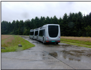
Bild A.36: Aufgrund der Mehrachslenkung lässt sich der Phileas nahezu spurtreu manövrieren
