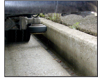
Bild B.15: Vor den Vorderrädern sind beidseitig Führungsrollen angeordnet, die über Tastarme starr mit den Achsschenkeln und dadurch kinematisch mit dem Lenkungsgestänge verbunden sind.
