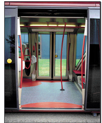
Bild A.41: Niedrige Einstiegsverhältnisse: 250 mm. (LOHR INDUSTRIE)
