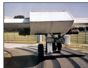
Bild E.10: Rundlaufanlage in Nantes. Im Vordergrund ist ein Sektor mit einer Asphaltbefestigung zu erkennen, im Hintergrund sieht man die helle Oberfläche des ebenfalls erprobten Percolé-Belages. (LA VIE DU RAIL)
