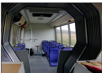
Bild 95b: Fahrzeugtyp Busbahn, Bauart Phileas, alle Wagenteile sind niederflurig ausgebildet. Blick auf die Rückwand der Fahrgastzelle, hinter der die Antriebseinheit stehend angeordnet ist. Die Leistungsübertragung erfolgt mechanisch entkoppelt „per Stromkabel“.
