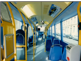
Bild A.31: Niederflriger Wagenkastenboden und Lichtöffnungen im Fahrzeugdach, Beispiel Cristalis in Lyon (TCL)
