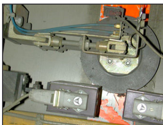
Bild B.34: Nicht nur die induktive Weg- erfassung findet in der Industrie Anwendung – hier eine Luftkissentransportvorrichtung für Wagenkasten, geführt an einer Farblinie. (Werk DWA, Bautzen)
