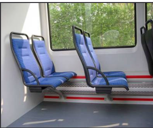
Bild A.38: Wagenteil 3, letzte Sitzreihe. Die Sitze werden an den Seitenwänden aufgehängt. (APTS)
