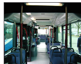
Bild A.8: Blick aus dem Wagenteil 2 des Van Hool AGG 300 nach hinten, Ausführung für Utrecht. Der Wagenkastenboden ist niederflurig und frei von Podesten.
