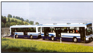
Bild 26: Omnibus-Anhängierzug mit zusätzlichem Fahrradtransportanhänger in der Schweiz. Die Zugerland Verkehrsbetriebe AG setzen dieses 28 m lange Gespann auf der Linie 1 nach Oberägi ein (REGIO TRANS 2001)
