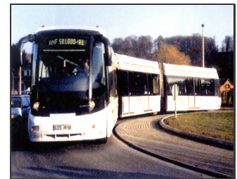
Bild B.1: Hervorragende Spurtreue mittels Allradlenkung. Eine Schleppkurve ist vom Fahrer nicht zu beachten, Beispiel GLT/TVR in Handlenkung. (GIE)
