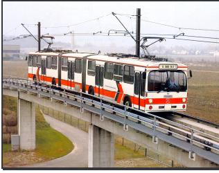
Bild 5: Einer der beiden Zweirichtungsprototypen der O-Bahn auf der damaligen Versuchsanlage in Rastatt (MERCEDES-BENZ OMNIBUSSE)
