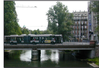
Bild 127b: Standard-Omnibus, beachte Bodenfreiheit, Fahrwerke, Dachaufbauten sowie Gestaltung der Gelenkverbindungen und Türöffnungen. Trotz geringerer Fahrzeughöhe wirkt das Fahrzeug wenig harmonisch.
