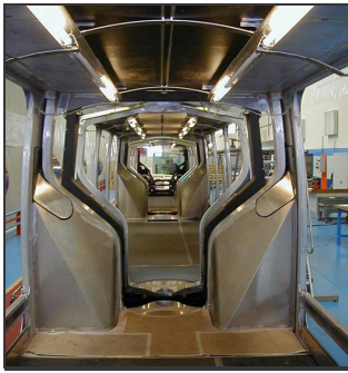
Bild A.44: Aluminiumaufbau. Die Laufachsen sind in den Gelenkverbindungen untergebracht. (LOHR INDUSTRIE)
