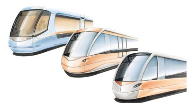
Bild 101: Gleiches Fahrzeug, aber individuelle Kopfmodule (LOHR INDUSTRIE)
