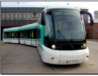
Bild A.16: GLT/TVR auf dem Betriebs- hof beim Versuchseinsatz auf der Trans Val de Marne, Paris. Das Fahr- zeug ist auf dem Betriebshof diesel- elektrisch und handgelenkt unterwegs.
