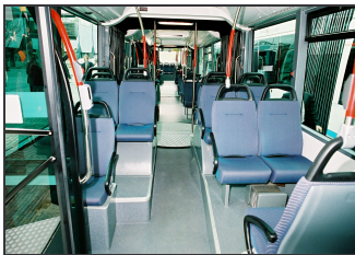
Bild 95a: Fahrzeugtyp Buszug, Bauart Van Hool, mit Podesten vor der angetriebenen Achse zur Unterbringung des Gelenkwellenstranges (rechts). Wagenteil 2 und 3 sind niederflurig. (HONDIUS)
