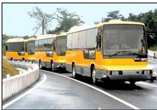
Bild D.2: Toyota und eine Variante der elektronischen Deichsel-funktionstauglich zumindest unter „Laborbedingungen“ (SPIEGEL ONLINE/TOYOTA)
