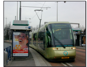
Bild A.40: Einpoliger Fahrdrabt beim Probetrieb des Translohr auf der TVM, Paris. Es können herkömmliche Pantographen verwendet werden.
