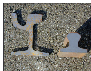
Bild B.24: Klassische Straßenbahn-Rillenschiene und Monoschiene (Profil Translohr) im Vergleich
