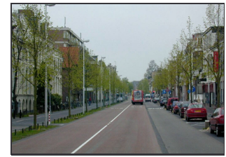
Bild 39: Besonderer Fahrweg mit halbhoher, überfahrbarer Bordstein, um eine hohe Störungsfreiheit sowohl des MIV als auch des HOV-Verkehrs gewährleisten zu können.
