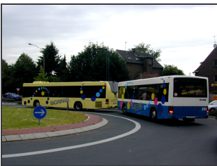
Bild 5: Beide Achsen des Personenanhängers werden angelenkt. So ist es möglich, dass der Anhänger nahezu spur-treu der Spur des Zugfahrzeuges folgt.
