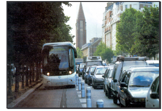
Bild 131: Bei guter Fahrbahnqualität ermöglichen gummibereifte Fahrwerke die Mitbenutzung von vorhandenen ÖPNV-Sonderfahrstreifen. (LA VIE DU RAIL)
