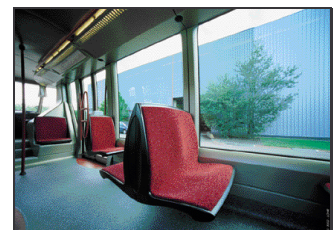
Bild A.42: Aufgehängte Sitze, große Fensteröffnungen, niederflurige Fahrgastzelle. (LOHR INDUSTRIE)
