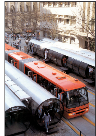
Bild 1: Bus Rapid Transit (BRT) und sein weltweit anerkanntes Vorzeigesystem: Hochfluriges Transportsystem zwischen Bus und Bahn in Curitiba, Brasilien. (VOLVO DO BRAZIL)
