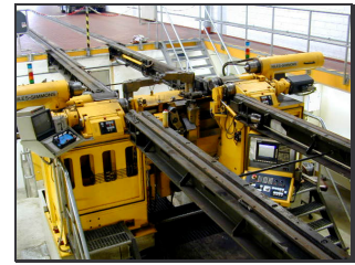
Bild 105a: Instandhaltung der Radsätze einer Schienenbahn. Beispiel: CNC-Radsatzfräsmaschine.
