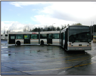
Bild B.3: Ein Van Hool AGG 300 in der Kreisfahrt. Drei der vier Achsen sind angelenkt.
