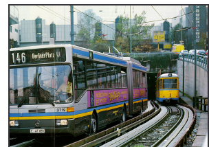
Bild B.12: Spurgeführter Duobus im Mischbetrieb mit Straßenbahnen auf der Tunnelstrecke in Essen (MERCEDES-BENZ OMNIBUSSE)
