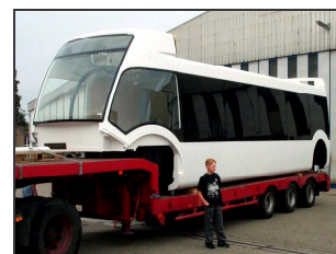
Bild A.34: Geklebte Kunststoff/Aluminium-Schalbauweise, grundlackiert mit geklebten Fenstern. Das Bauteilgewicht beträgt rund 2 t. (FOKKER SPECIAL PRODUCTS)
