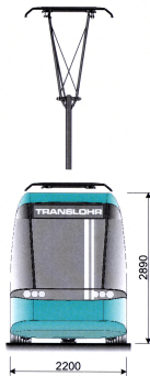
Bild B.37: Bei beengten Verhältnissen wird nicht nur eine automatische Querführung verkehrsflächensparend sein, sondernes wäre gleichfalls auch auf ein kleinprofiliges Fahrzeugzurückzugreifen. (LOHR INDUSTRIE)
