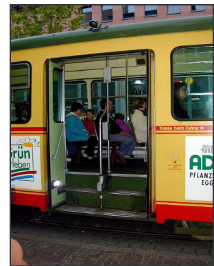
Bild B.6: Hochflur-Straßenbahn - inakzeptabler Zugang trotz Spurführung. Heute weitgehend durch Niederflurfahrzeuge abgelöst.
