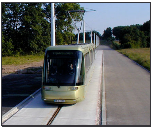
Bild 97a: Moderne Nutzfahrzeugtechnologie und Beton-Gleitschalungstechnik sorgen im Zusammenspiel für einen ausgezeichneten Fahrkomfort. (LOHR INDUSTRIE)
