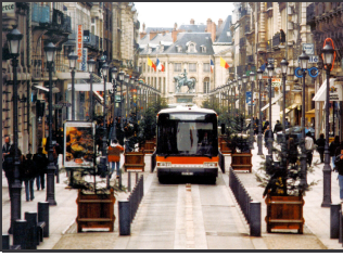
Bild 118a: Orléans vor der Einführung der Straßenbahn, Blick auf die Place du Martroi mit der Statue Jeanne d'Arc. Beachte die Vielzahl der Absperrelemente. Aufgrund der geringen Fahrgeschwindigkeit kann das Lichtraumprofil gering bemessen werden. (TYSON)
