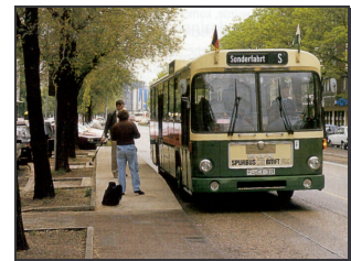
Bild B. 26: Definierte Sollspur über ein in der Fahrbahndecke eingelassenen Leitdraht. Die Technik erhielt in Fürth nie eine allgemeine Zulassung. (BURMEISTER)
