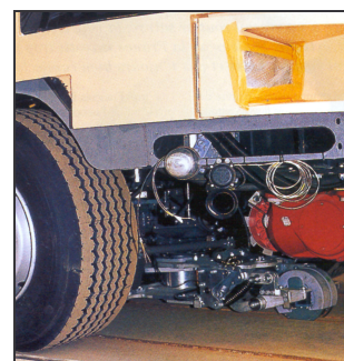
Bild A.19: Angetriebene Vorderachse mit dem Führungsgestell unter der Fahrerkabine. (LA VIE DU RAIL)
