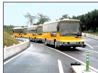
Bild 22: Toyota und eine Variante der elektronischen Deichsel. (SPIEGEL ONLINE/TOYOTA)
