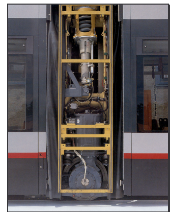
Bild A.47: Radführungs- und Antriebstechnik mit Einzelrädern, vertikaler Aufbau am Beispiel ULF (SGP VERKEHRSTECHNIK)
