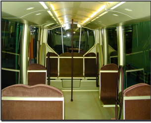
Bild A.43: Hochflurige Fahrerkabine, die bei dem Prototypen nur über eine umklappbare Sitzkonstruktion zu erreichen ist (Bildmitte). Der Bauraum unter der Fahrerkabine wird zur Unterbringung der Antriebstechnik genutzt.
