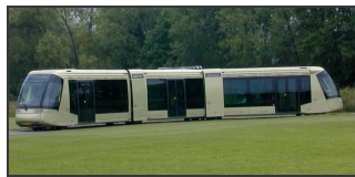
Bild 30: Fahrzeugtyp Straßenbahn auf Gummireifen, Beispiel: Bauart Translohr
