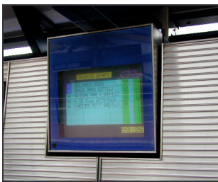
Bild 52: Dynamische Fahrgastinformationssystem SIV mit Monitor
