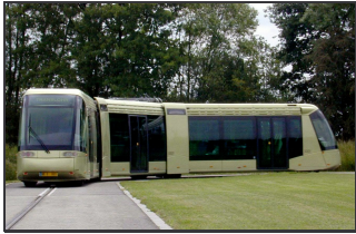
Bild B.18: Einfahrt des Prototypen in einen Gleisbogen mit einem Halbmesser von nur 10,50 m. Teststrecke des Translohr in Duppigheim.
