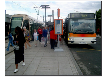
Bild 85: Tür-zu-Tür-Umsteigemöglichkeit zwischen der Linie A und den Anschlusslinien der Vororte (BENJARI)
