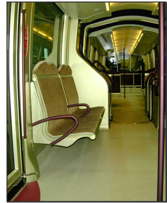
Bild 95c: Fahrzeugtyp Straßenbahn auf Gummireifen, Bauart Translohr. Niederflrige Fahrgastzelle, wobei die Fahrwerke vorteilhaft in den Gelenkmodulen untergebracht sind. Die Antriebseinheit liegt unterflur jeweils an den Fahrzeugenden.
