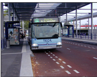
Bild 54: Geradlinige Haltestellenanfahrt und damit nahezu spaltfreier Ein- und Ausstieg. Die optische Spurregelung ist zum Zeitpunkt der Aufnahme (2001) allerdings noch nicht betriebsbereit gewesen.
