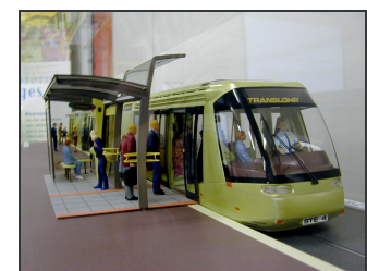
Bild 76: Modell einer typischen Trans- lohr-Haltestelle mit höhengleichem Einstieg
