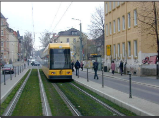
Bild 120: Unkonventionelle Mittellage-Haltestellen mit Fahrbahnanhebung. Die Wartefläche liegt im Seitenraum.
