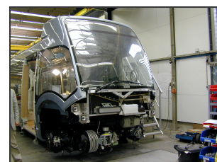
Bild A.33: Wagenfront mit der weit nach vorne gerückten servo-unterstützten Vorderachse.
