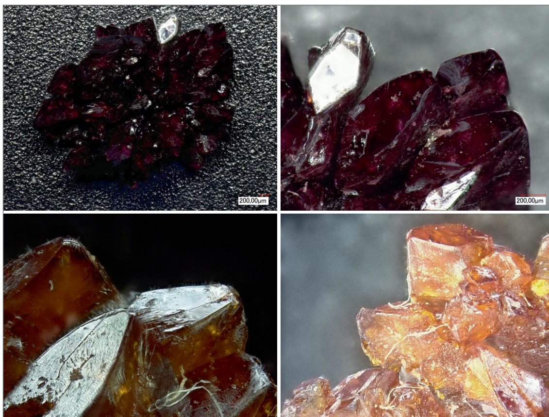
Abb. 38: Spiropyran-Kristalle unter einem Lichtmikroskop. Oben links in 50-facher Vergrößerung nach Auskristallisieren, oben rechts 150-fache Vergrößerung. Unten links bei 200-facher Vergrößerung nach einigen Stunden unter Tageslicht, unten rechts bei 100-facher Vergrößerung. Die rötliche Farbe (oben) weicht einer gelb-goldenen (unten).
