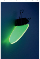
Fluoreszenzkollektor aus Plexiglas und Farbstoff aus einem Teströhrchen
