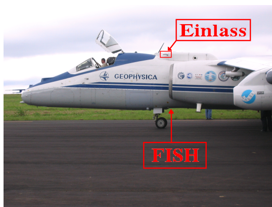
Abbildung 3.2: Das russische Höhenforschungsflugzeug „M-55 Geophysica“ (oben, Bild von Fábio H. Silva dos Santos). Die Positionen von FISH und Einlass sind im nebenstehenden Bild zu sehen (Bild von Dr. Fred Stroh).
