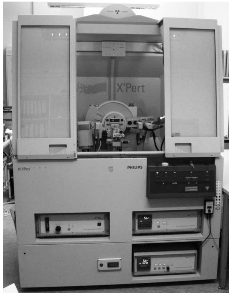
Abbildung 2.2: Das Philips X'Pert PRO Diffraktometer
