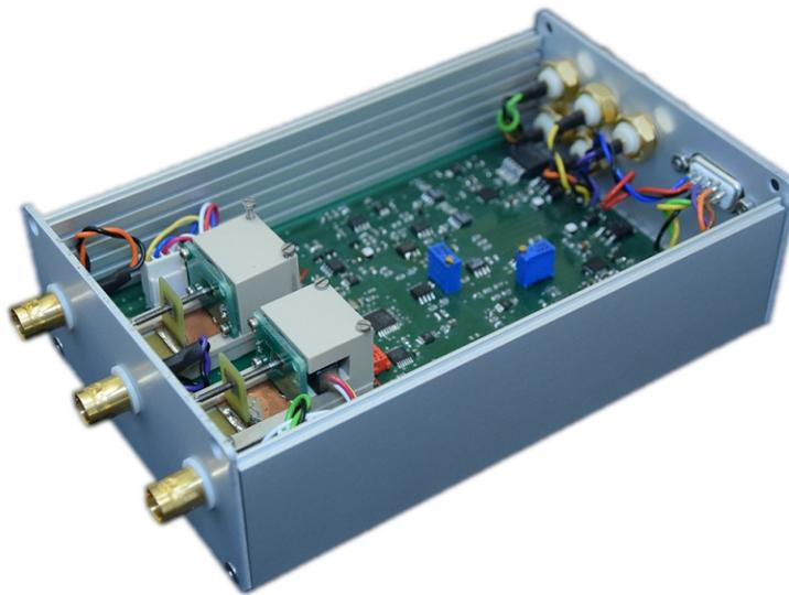
Abbildung 5.16: Realisierter, zweikanaliger ladungssensitive Verstärker
