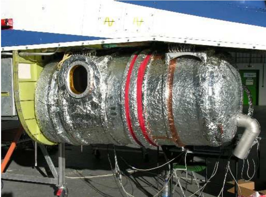
*Abbildung 5: CRISTA-NF integriert in Bay-1 der M55-Geophysika, aufgenommen von der Steuerbordseite des Flugzeugs; deutlich sichtbar ist das Zink-Selenid Fenster, durch das IR-Strahlung in das Instrument einfällt.*
