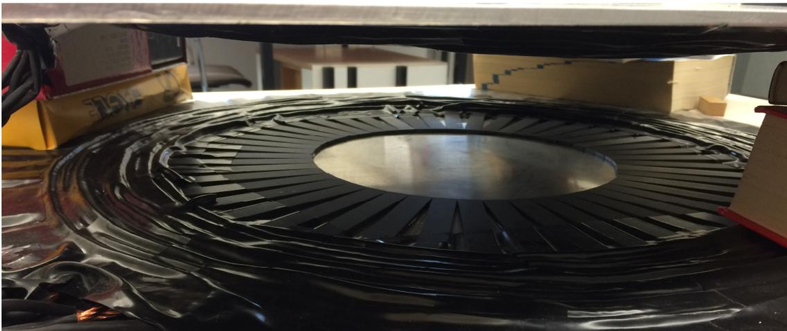
Abbildung 4.1: Prototyp eines induktiven Ladesystems. Blick auf die Primärspule mit einer Aluminiumplatte, darauf kreisförmig verbundenen Ferritstäben aus dem Werkstoff Mannifer 198 und darauf spiralförmig verlegter und fixierter Kupferlitzendraht.
