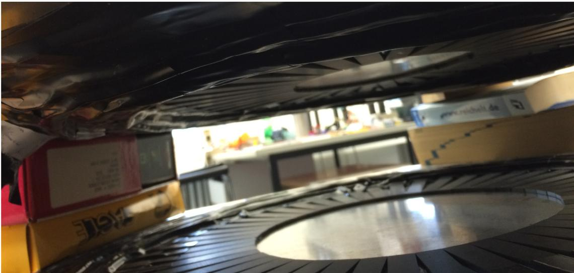
Abbildung 4.2: Prototyp eines induktiven Ladesystems. Blick auf die Sekundärspule mit einer Aluminiumplatte, darauf kreisförmig verbundenen Ferritstäben aus dem Werkstoff Mannifer 198 und darauf spiralförmig verlegt und fixiert Kupferlitzendraht. Die Abmessungen sind insgesamt etwas kleiner als bei der Primärspule.
