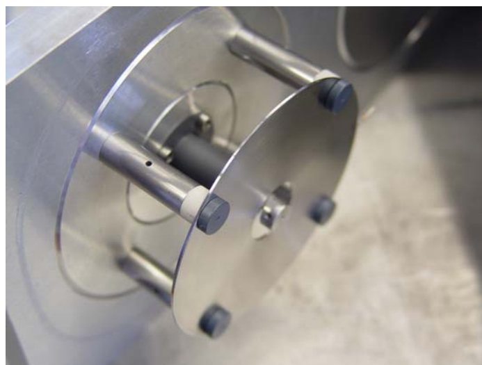
Abbildung 18: Repelleranordnung 3. Edelstahlkapillare mit Hilfsrepeller; vergrößerte, mit Plastikschraben gehaltene Repellerplatte.
