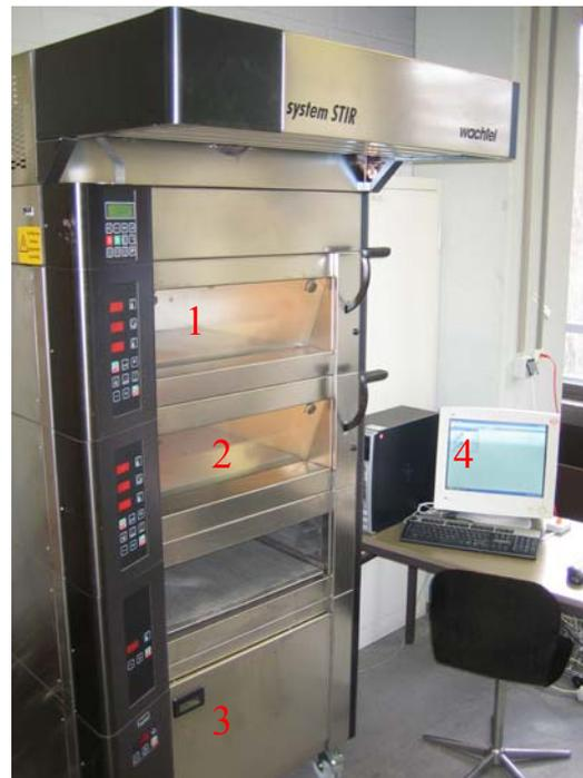
**Abb. 3.1** Backofen Mini Piccolo2 von Wachtel (Hilden/Deutschland): Kammer 1: STIR-Backkammer (selektiv transformiertes IR) mit keramisch beschichteten Flachemitterplatten; Anteil IR-Strahlung (3.0-6.3 $\mu$ m) im Vergleich zu konventioneller Technik laut Herstellerangabe von 30 auf 90 % erhöht, Kammer 2: konventionelle Backeinheit mit Keramik-Flachheizkörper in Stahlrohren, 3: Gärschrank, beide Kammern und Gärschrank angeschlossen an 4: PC mit Software WinServer 2004
